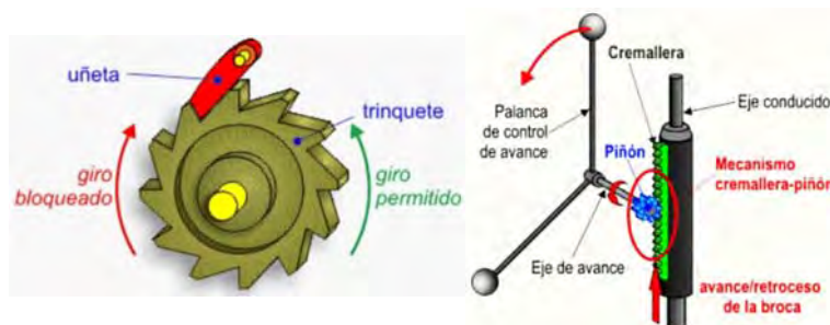
Figura 13. Trinquete (izquierda) y Piñón-Cremallera (derecha).
