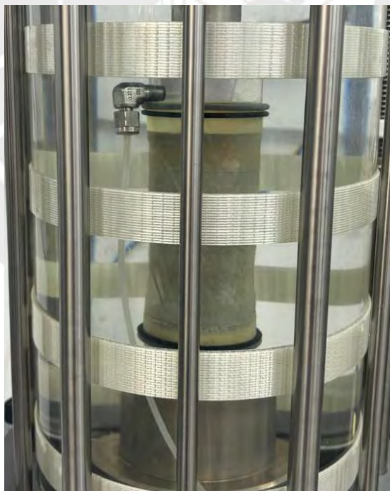
Figura 3.16 Especimen al término de ensayo triaxial
