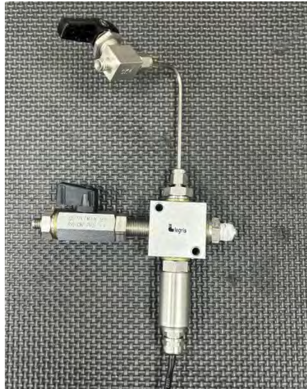
Figura 3.12 Medidor de Presión de Poros GDS con adaptador hacia la válvula de drenaje inferior
