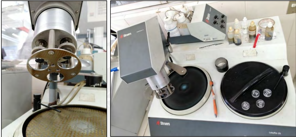
Figura 77. Lado izquierdo muestra el cabezal para uso de 3 briquetas y en lado derecho muestra el equipo mecanizado para desbaste y pulido
