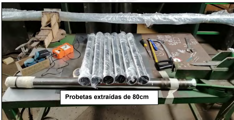
Figura 52 Extracción de probetas en tuberías 304L y 316L.
