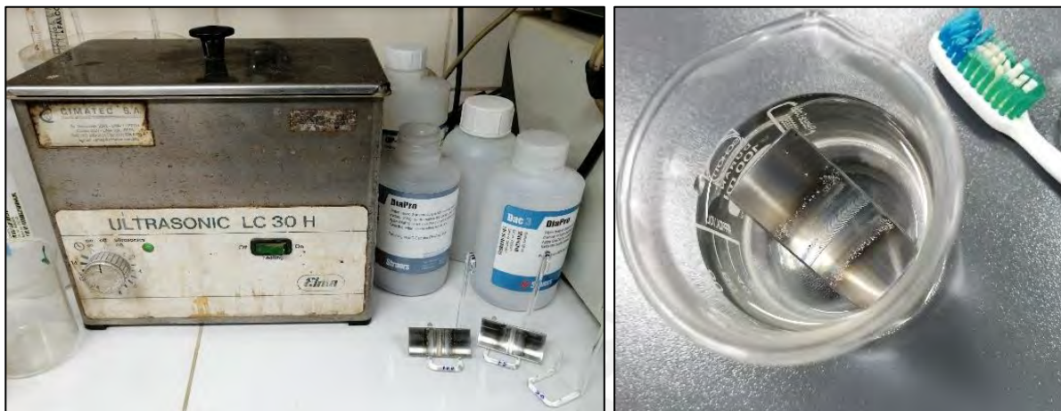
Figura 97. Equipo de limpieza ultrasónica para muestras corroídas luego del ensayo de corrosión.
