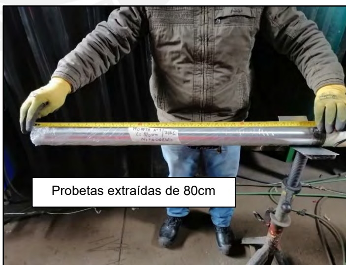
Figura 49. Corte manual con arco de sierra para extracción de probetas en tramos aproximados de 80cm.
