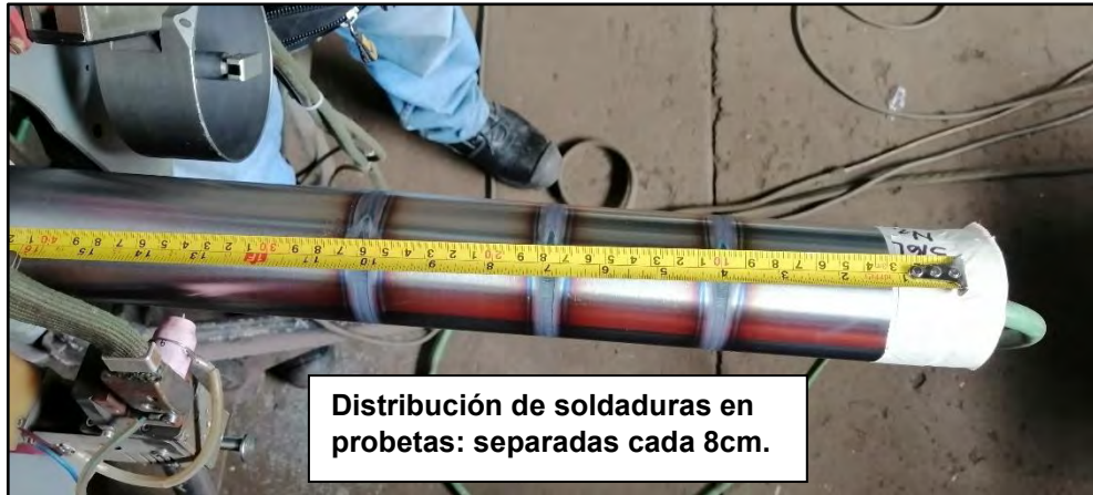
Figura 50. Líneas de fusión circunferenciales realizadas en las probetas. Se realizaron 5 cordones separados cada uno a 8 cm aproximadamente.
