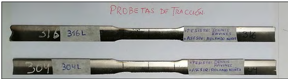
Figura 73. Probetas de tracción 304L y 316L según estándar ASTM A-370-21, fabricadas en el taller de manufactura de la PUCP.
