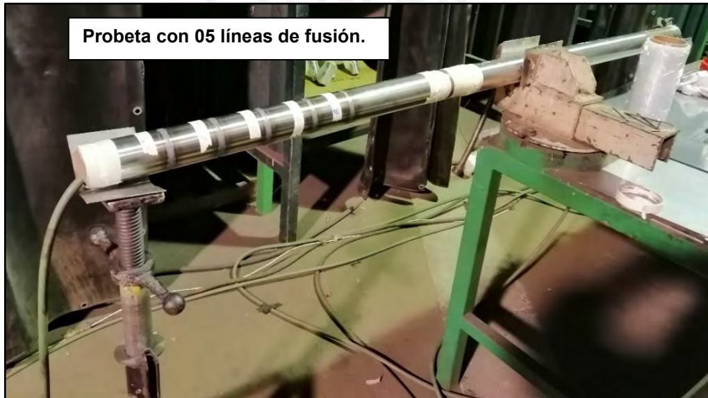
Figura 51. La imagen muestra probeta con las 05 soldaduras autógenas.
