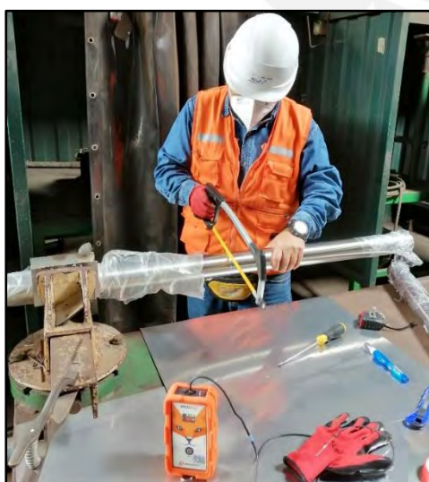
Figura 49. Corte manual con arco de sierra para extracción de probetas en tramos aproximados de 80cm.
