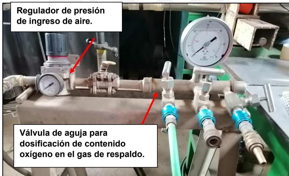
Figura 58. Accesorios de control para dosificación de aire en concentraciones de 50,75,100 y 200 ppm de oxígeno.
