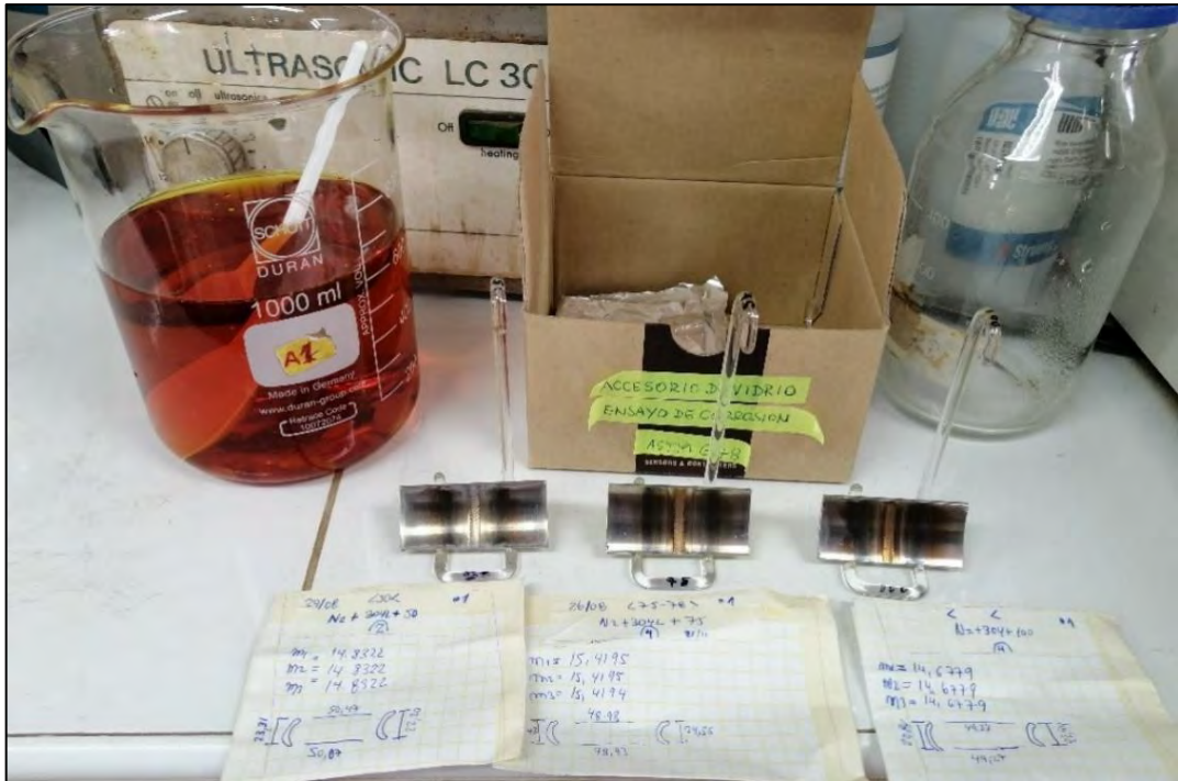
Figura 95. Muestras seleccionadas para el ensayo de corrosión por picadura.
