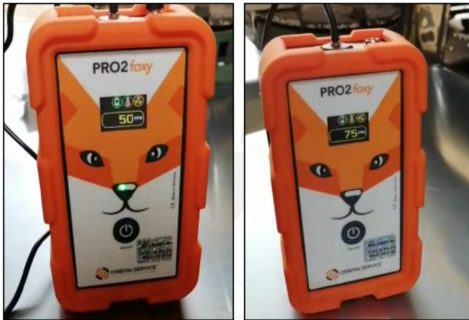
Figura 59. Monitoreo de dosificación exacta de ppm de oxígeno: 50 y 75 ppm
