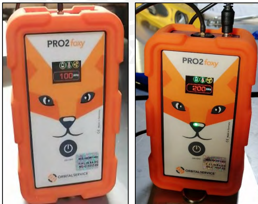
Figura 60. Monitoreo de dosificación exacta de ppm de oxígeno: 100 y 200 ppm
