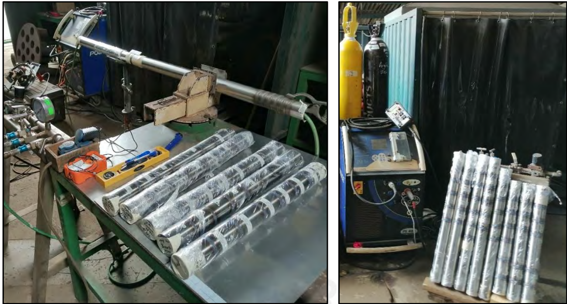
Figura 68. Probetas extraídas y debidamente etiquetadas.
