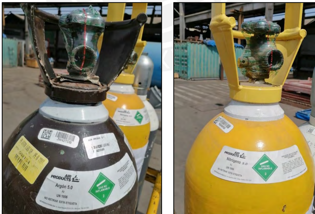
Figura 34. Muestra los cilindros de gas argón y nitrógeno ultrapuros adquiridos.
