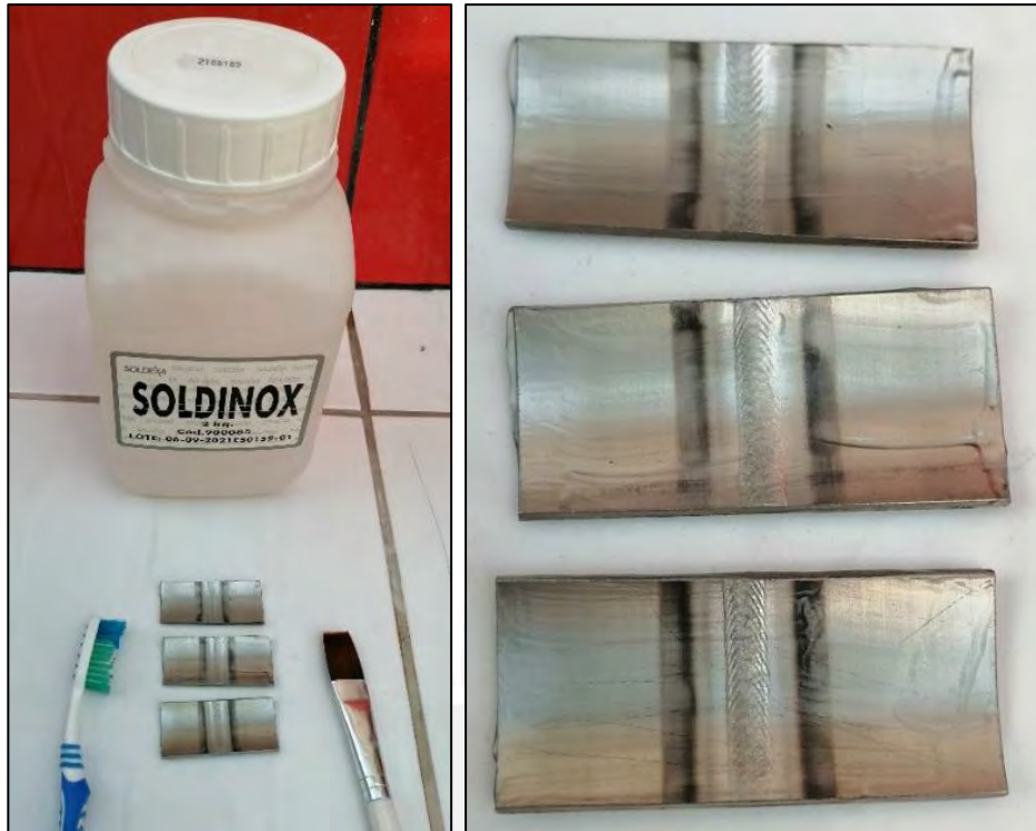
Figura 87. Proceso de pasivación en la cara de las soldaduras.
