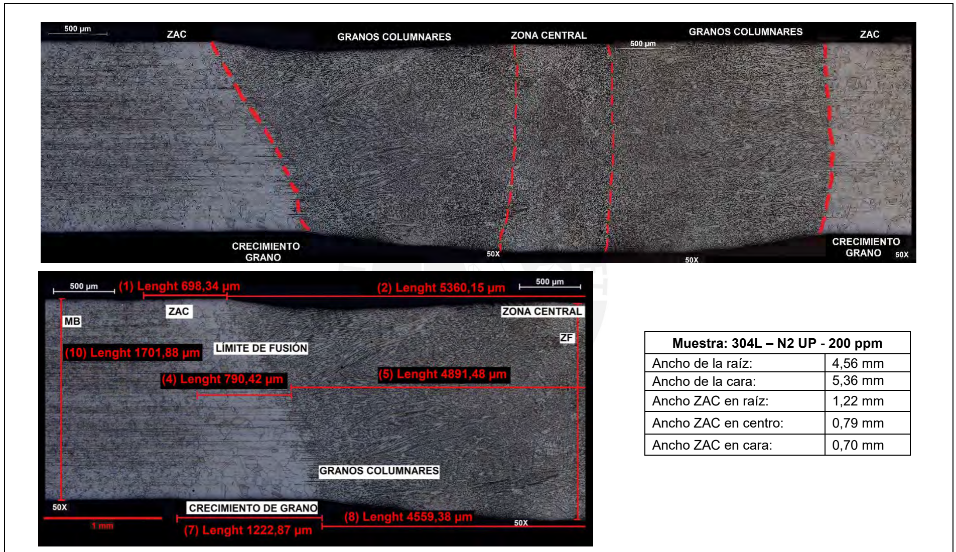
Figura 110. Micrografía y dimensiones en la sección transversal de la ZF de la muestra: 304L -N 2 UP – 200ppm.
