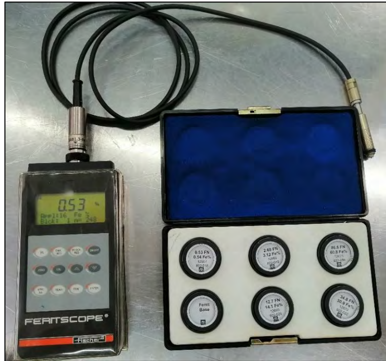
Figura 82. Ferritoscopio para la medición del contenido de ferrita en la ZF.
