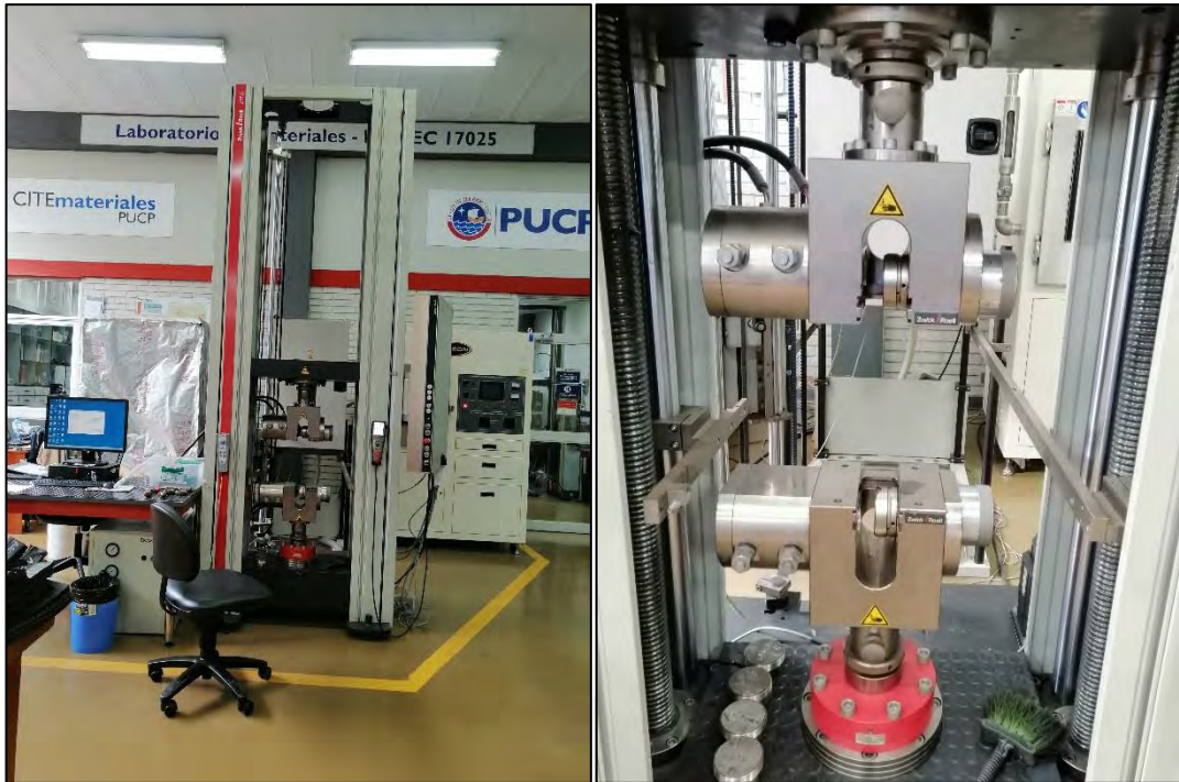
Figura 71. Máquina de tracción universal de carrera larga de hasta 25Ton.
