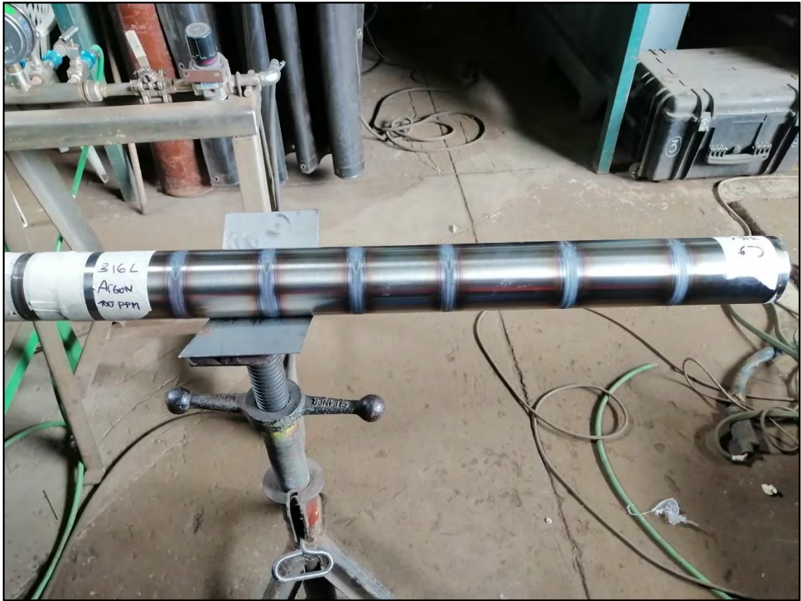
Figura 65. Líneas de fusión circunferenciales en probeta 316L empleando gas de respaldo Argón UP con 100 ppm de oxígeno.
