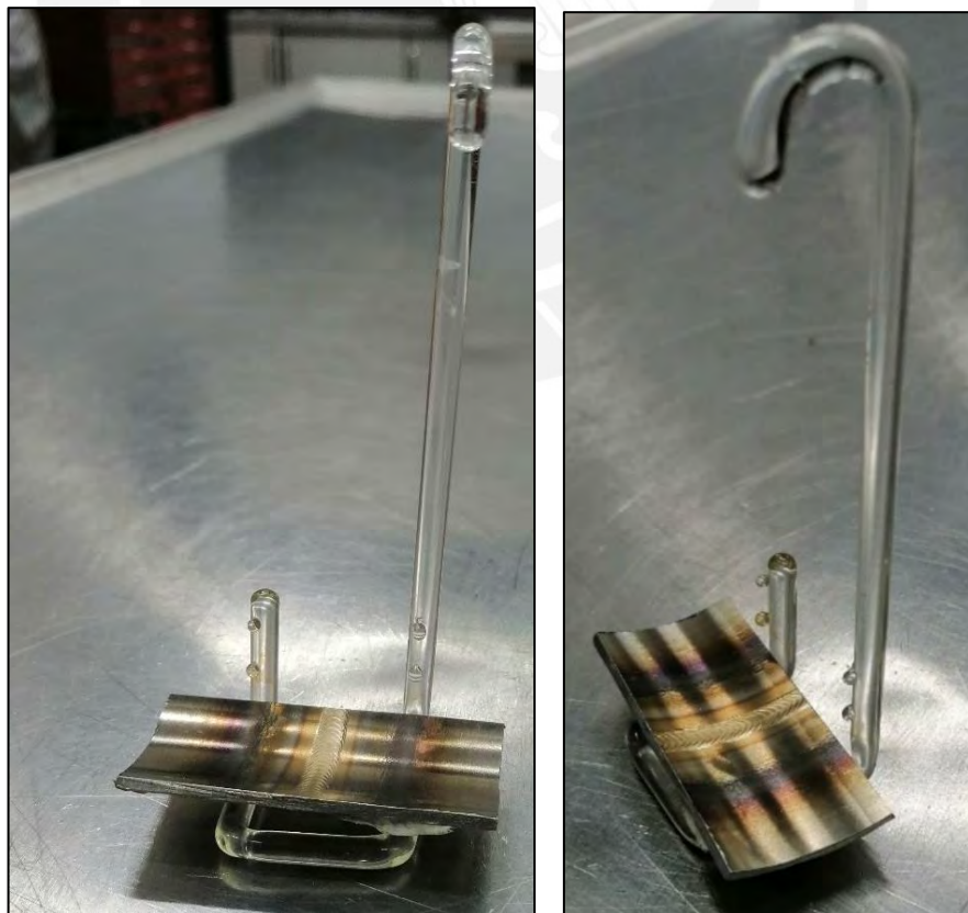
Figura 88. Diseño de soporte de vidrio para ensayos de corrosión.
