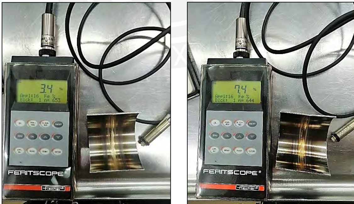
Figura 120. Valores medidos de % de ferrita en la raíz de la ZF en el acero inoxidable 304L y 316L.
