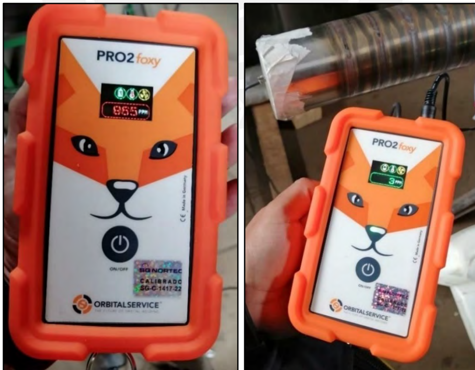
Figura 56. Monitoreo de evacuación de oxígeno al interior de la tubería.
