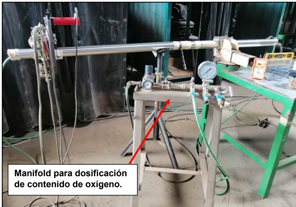
Figura 57. Manifold dosificador de aire para concentraciones de 50,75,100 y 200 ppm de oxígeno.
