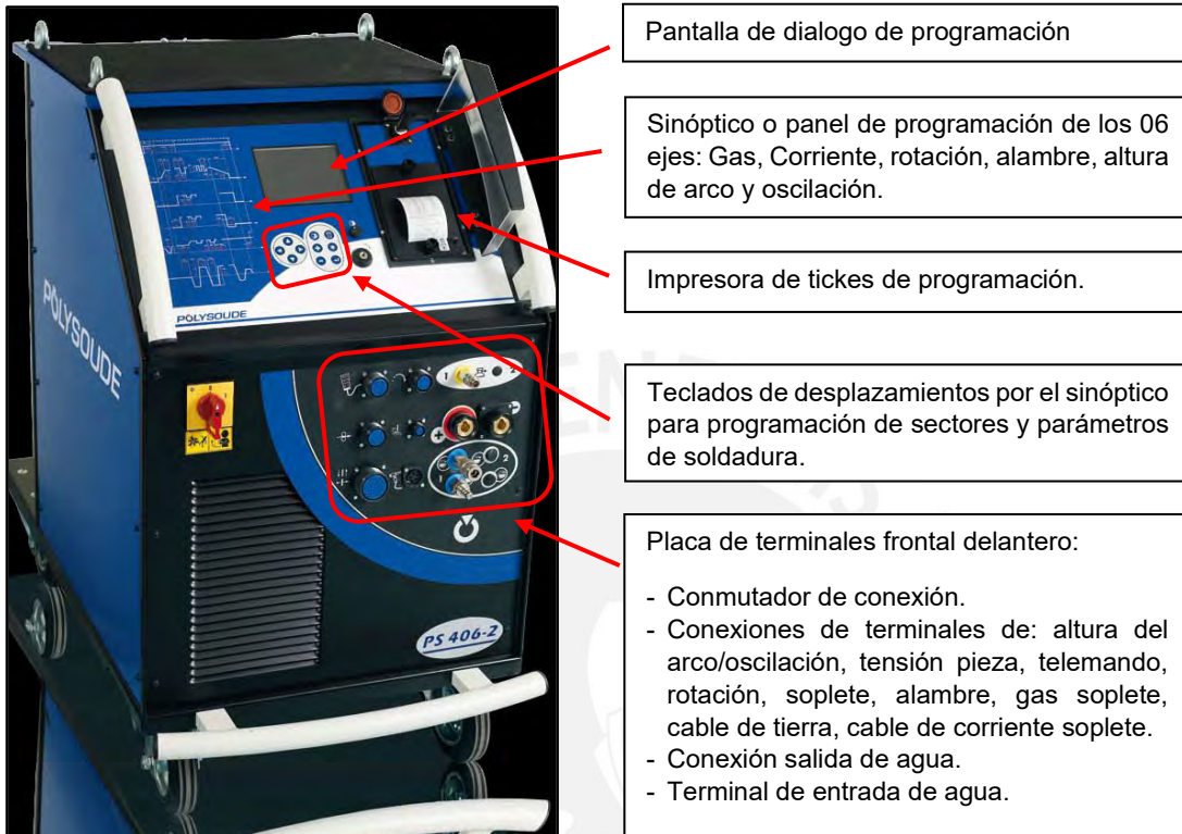
Figura 35. Vista de parte frontal del generador PS 406.
