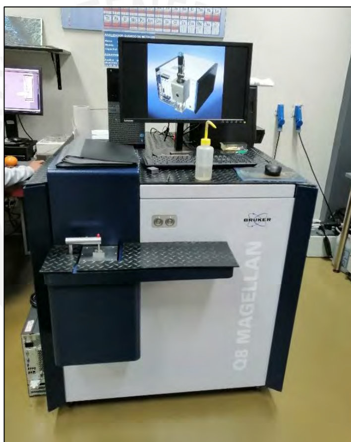
Figura 70. Espectrómetro de emisión óptica por chispa para análisis químico.
