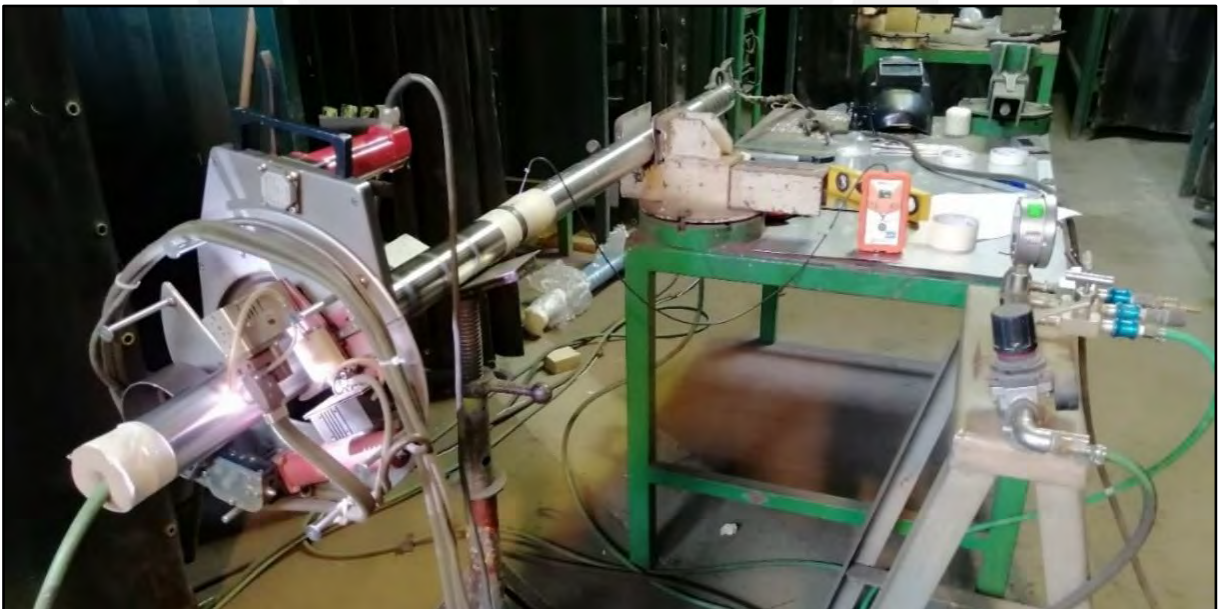
Figura 62. Ejecución de soldadura autógena orbital TIG pulsado (Líneas de fusión circunferenciales).
