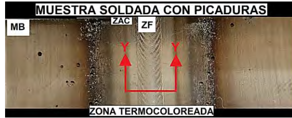
Figura 128: Micrografías de picaduras en una muestra del tipo 304L- Ar UP - 50 ppm , luego del ensayo de corrosión según ASTM G48 [18]. En el corte X-X se observa que las picaduras se ubican en el MB a una distancia de 7mm a 11 mm desde el centro de la ZF. En el corte Y-Y, se observa que no existe presencia de picaduras en la zona de crecimiento de grano (ZAC) y en la zona de granos columnares de la ZF.
