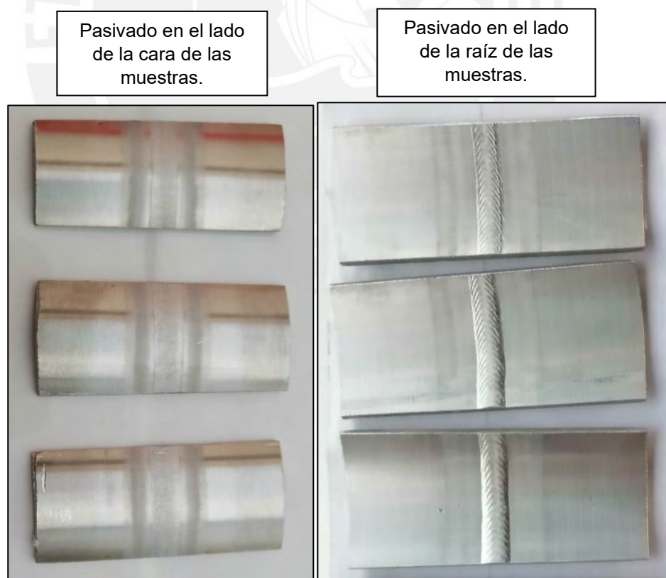
Figura 102. Muestras pasivadas por ambos lados de las líneas de fusión (cara y raíz).
