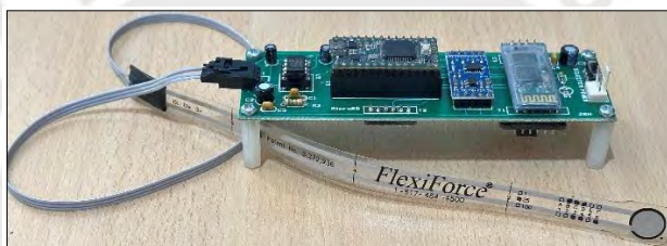
Figura 3-9. Tarjeta principal del bastón con el sensor de fuerza.
