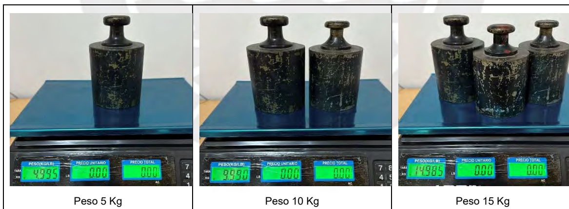
Figura 3-10. Fotos de los pesos utilizadas para la obtención de la curva del sensor de fuerza A201.
