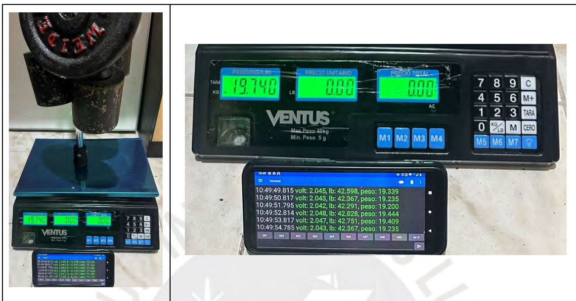
Figura 4-8. Comprobación del bastón con un peso de 19.840 Kg (Fuente: elaboración propia).
