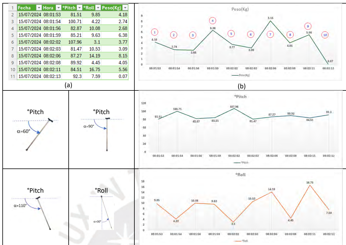
Figura 4-28. Interpretación de las señales generadas por el bastón durante la marcha (Fuente: elaboración propia)
