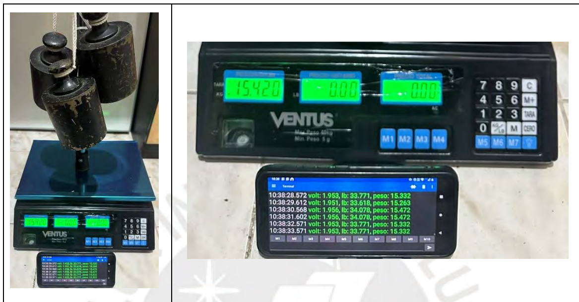
Figura 4-7. Comprobación del bastón con un peso de 15.490 Kg (Fuente: elaboración propia).
