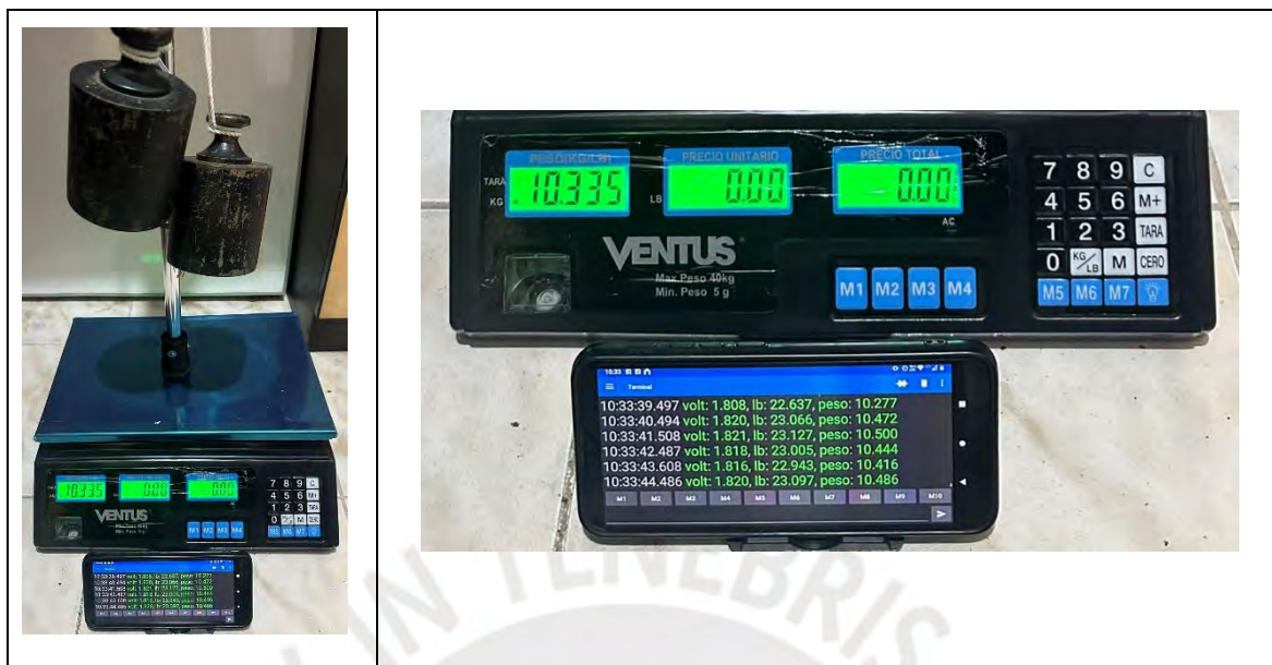
Figura 4-6. Comprobación del bastón con un peso de 10.490 Kg (Fuente: elaboración propia).
