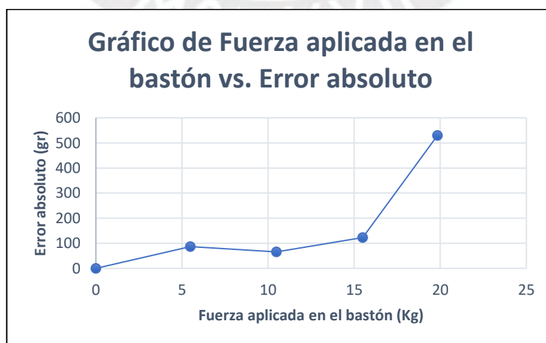
Figura 4-9. Gráfico de Fuerza aplicada sobre el bastón vs Error absoluto (Fuente: elaboración propia)
