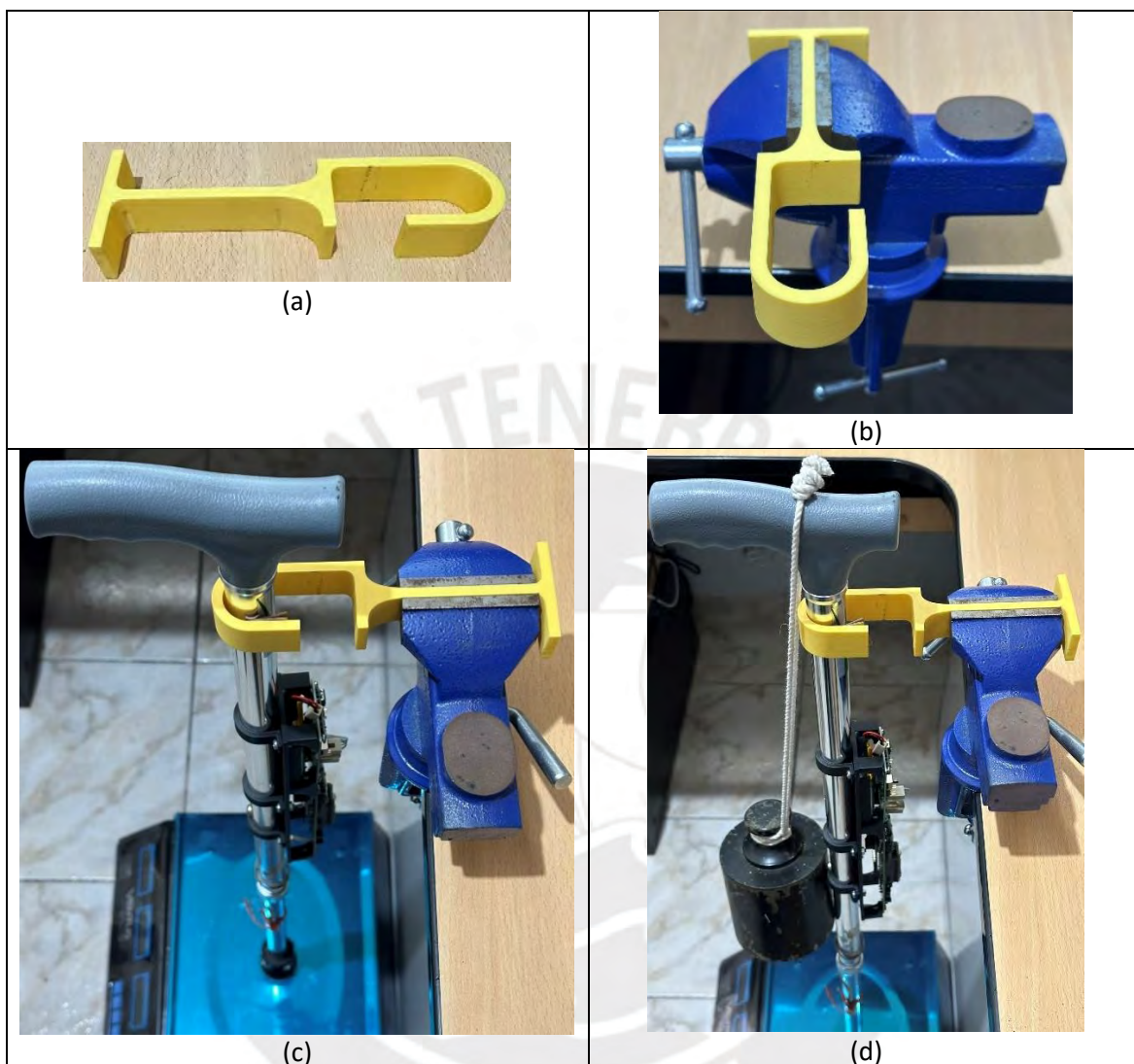
Figura 4-3. Validación de los pesos sobre el bastón (Fuente: elaboración propia).
