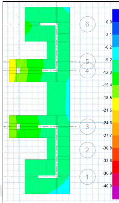
Figura 64 Esfuerzos debido a cargas en servicio (ton/m 2 ).
