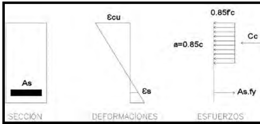
Figura 18. Distribución de esfuerzos, deformaciones y bloque de compresiones Fuente: Ottazzi, G. 2016.
