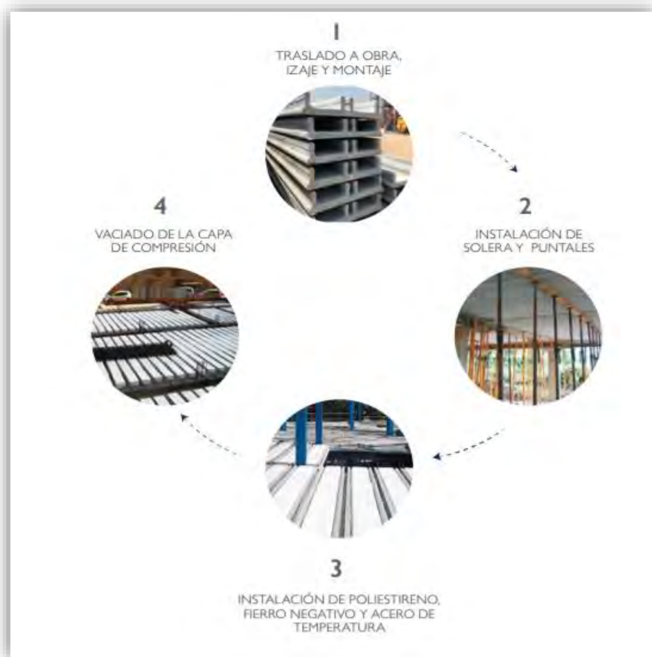
Figura 4. Detalle del proceso constructivo con prelosas pretensadas.
