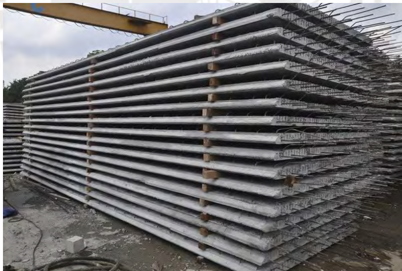
Figura 72. Colocación de tacos de madera para prelosas macizas
