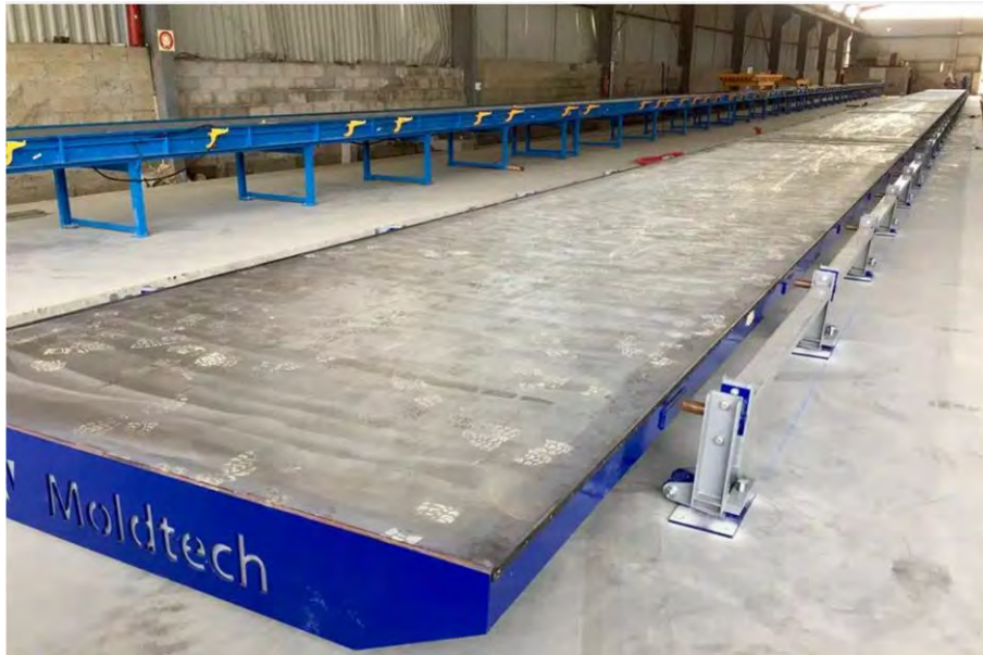
Figura 65. Molde para prelosas
