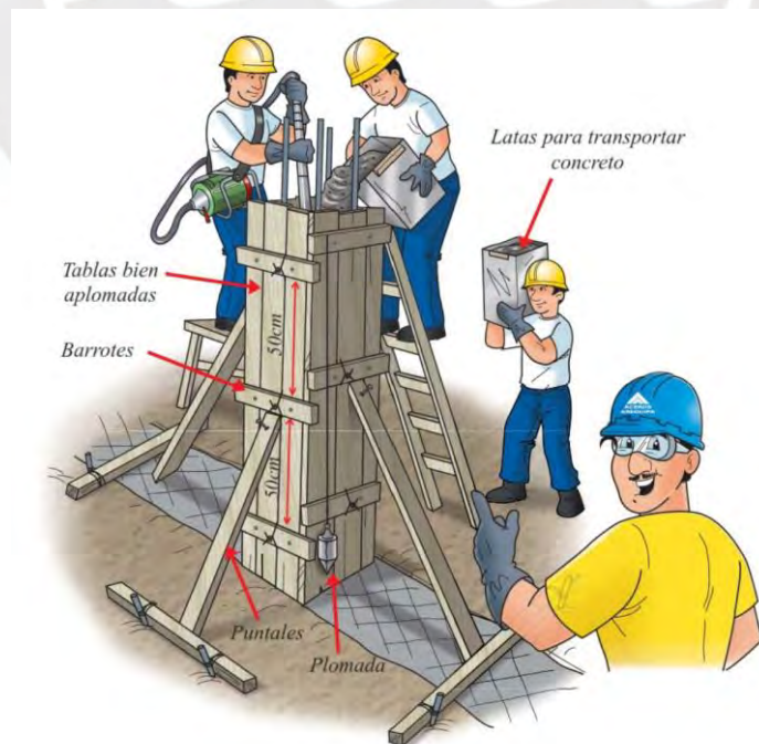
Figura 28. Vaciado de concreto en columna
