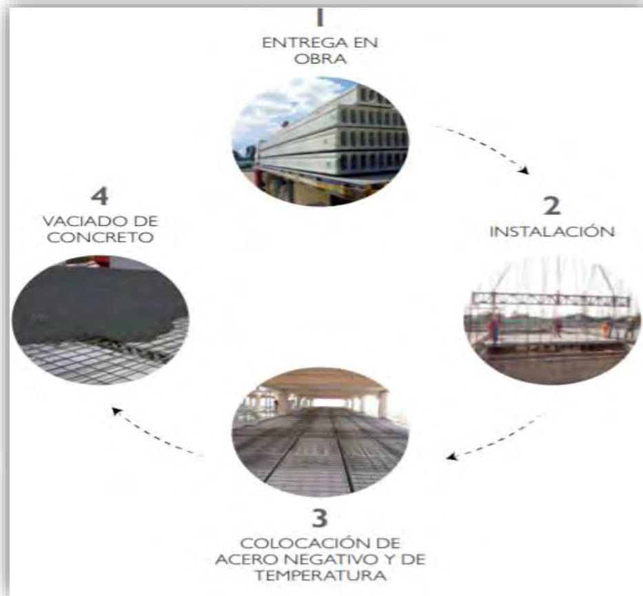
Figura 15. Proceso constructivo de placas alveolares.
