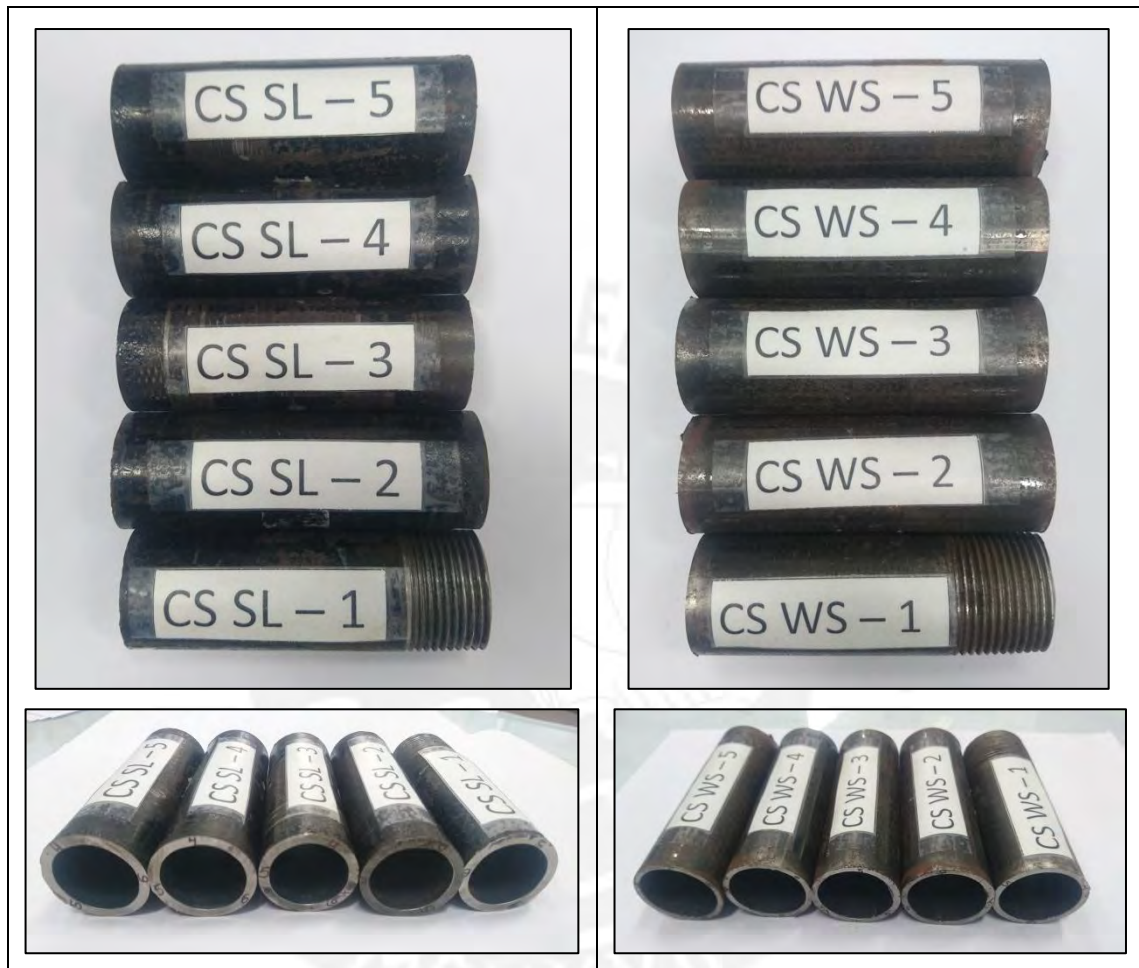
Fig. 2.25: Izquierda: Probetas de acero al carbono sin costura (CS SL), derecha: Probetas de acero al carbono con costura (CS WS).
