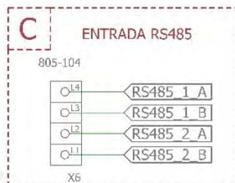
Figura 2.53. Borneras para la conexión de la salida del HUB RS-485.
