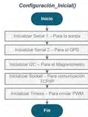
Figura 2.69. Diagrama de Flujo de la configuración inicial.
