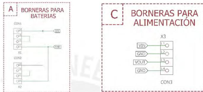
Figura 2.39. Borneras para la batería y la salida de la tarjeta de alimentación.
