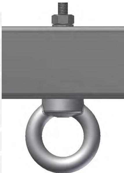
Figura 2.22. Conexión entre el cáncamo y el tubo cuadrado central de la estructura.
