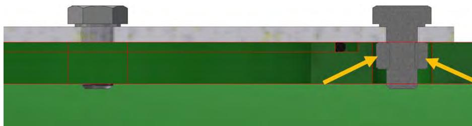
Figura 2.31. Detalle de la incrustación de tuercas en el USV.
