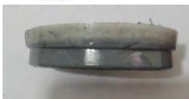
Figura 10: Fase precipitada de partículas magnéticas diferenciada de la resina epóxica.
