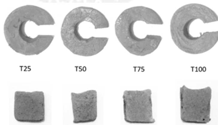
Figura 27: Toma de muestras de las probetas toroidales para la toma de imágenes SEM
