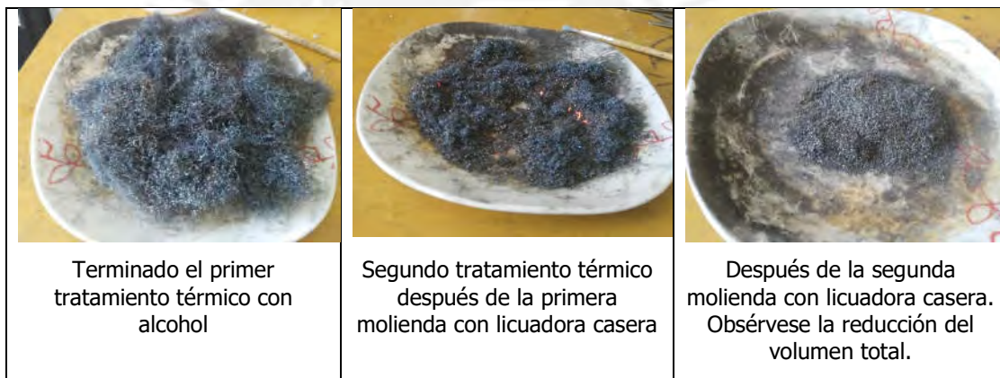
Figura 6: Formación de las partículas ferromagnéticas utilizadas en la experiencia previa a partir de viruta metálica
