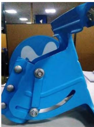
Figura 6. Fotografía de corrección de offset de antena con indicador
