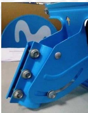
Figura 5. Fotografía Reforzamiento de abrazadera de mástil
