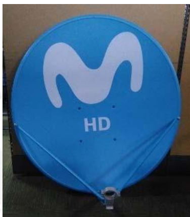
Figura 4. Fotografía de nuevos soportes de LNB
