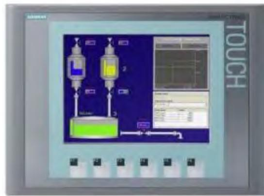
*Fig 37. Visualizador HMI: KPT 600
