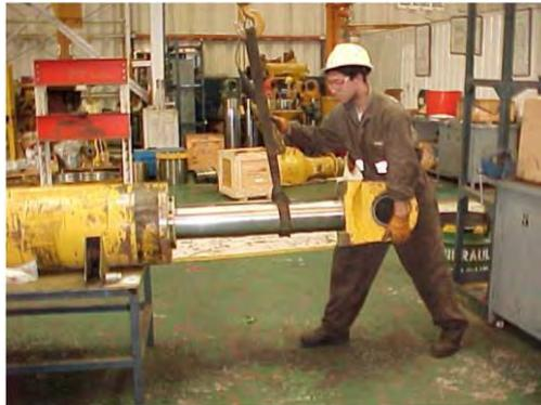
Fig 9. Montaje del vástago en el proceso de armado.
