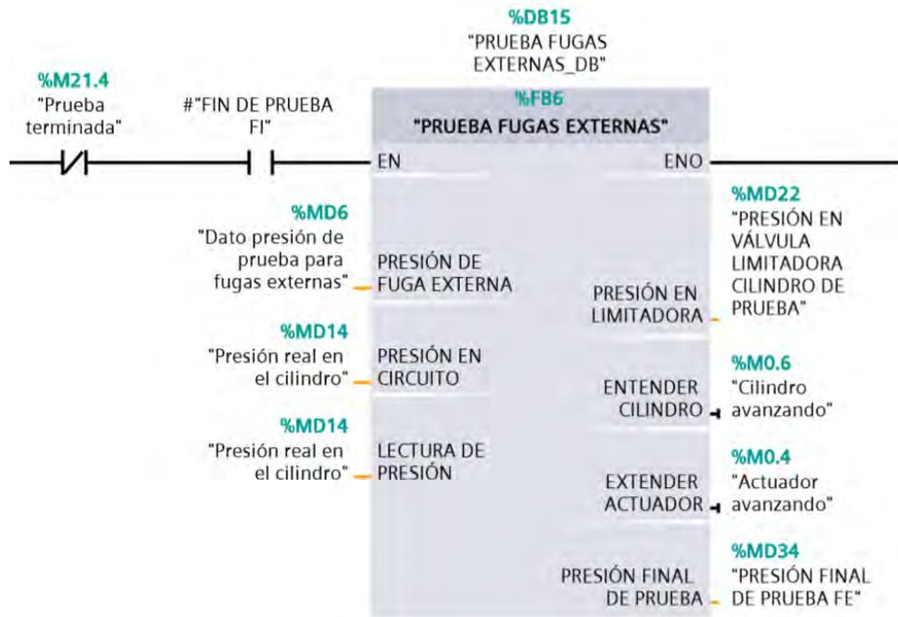
Fig 59. Bloque de función: prueba de fugas externas
