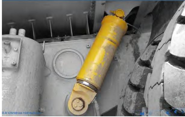
*Fig 2. Cilindro montado totalmente contraído*
