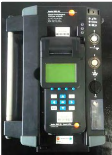
Figura 3.5 Analizador de emisiones Testo 350 XL.
