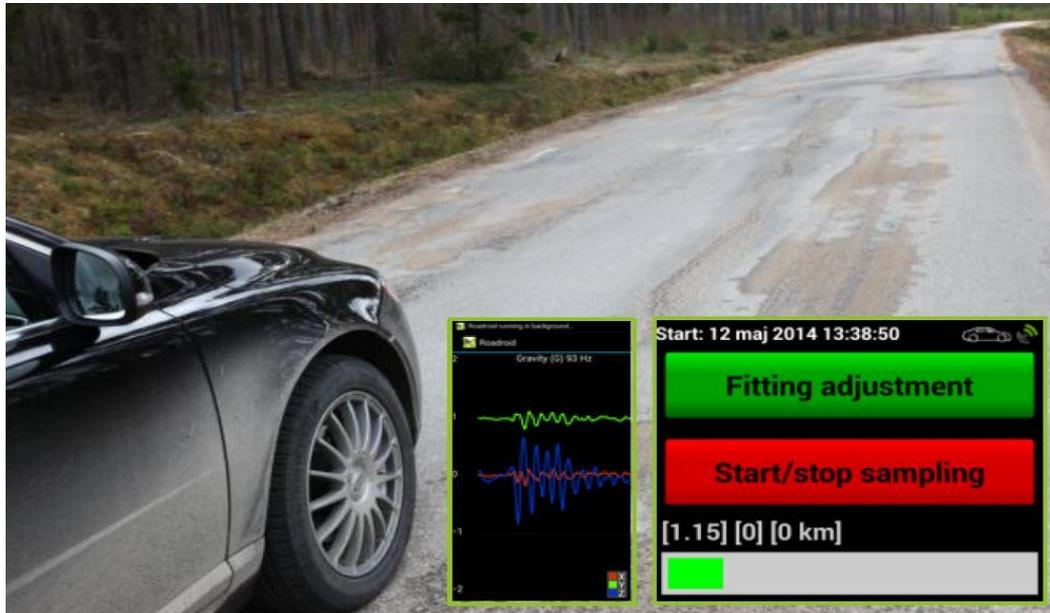
Figura 09. Uso de la aplicación Roadroid en carreteras.
