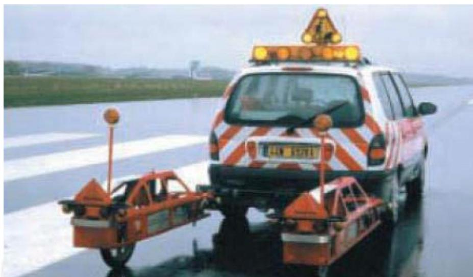
Figura 03. Perfilómetro APL. Fuente (Nava, 2007)
