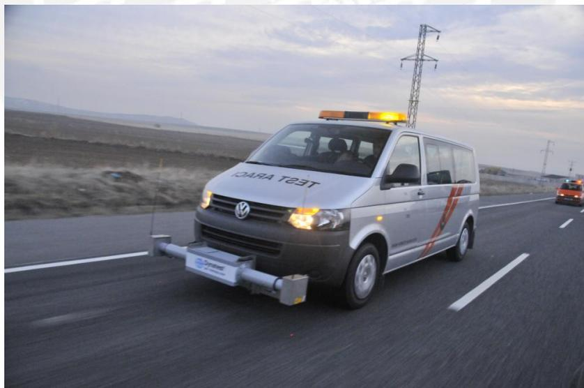
Figura 02. Perfilómetro láser de clase 1.
