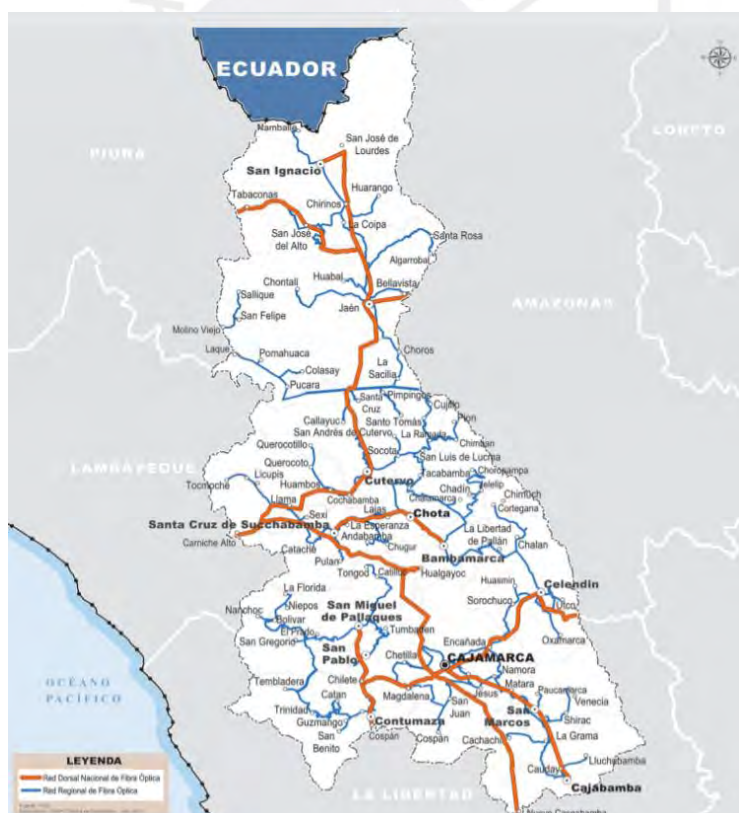
Figura 32. Tendido de red dorsal nacional y regional de fibra óptica en Cajamarca. Tomado de “Cajamarca, camino al desarrollo,” por Ministerio de Transportes y Comunicaciones [MTC], 2016 ( https://www.mtc.gob.pe/transportes/caminos/normas_carreteras/obras_mapas/Cajamarca.pdf ).
