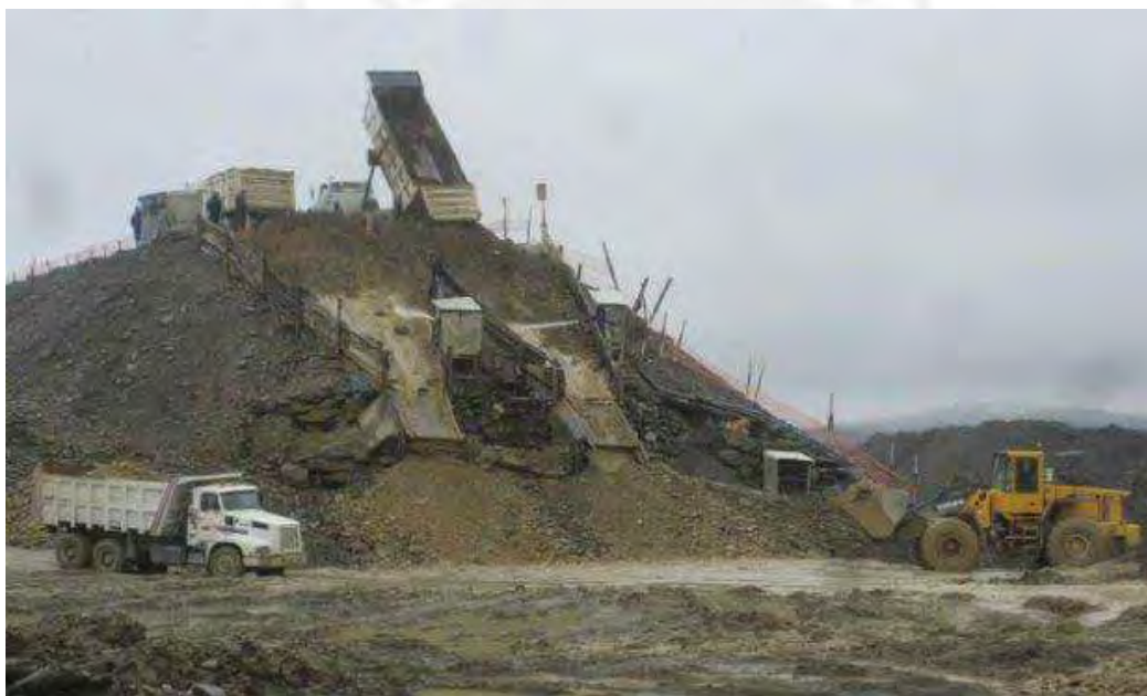
Figura n° 05. Maquinaria pesada en operación arreando y transportando material aluvial mineralizado para su lavado en 2 chutes - Sector Ananea - Chaquiminas - Pampa Blanca.
