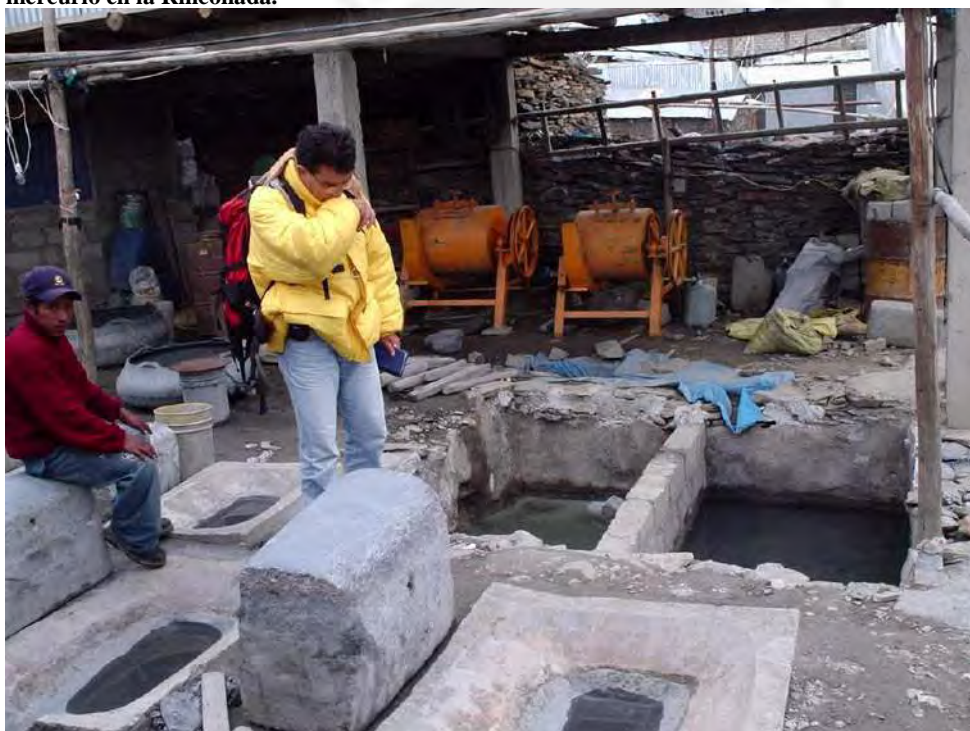
Figura n° 11. Conjunto de quimbaletes para el recate del oro mediante amalgamación con mercurio en la Rinconada.
