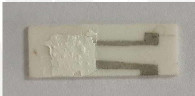
Figura 11. Capa de zeolita-Y activada sobre la superficie de óxido de estaño dopado
