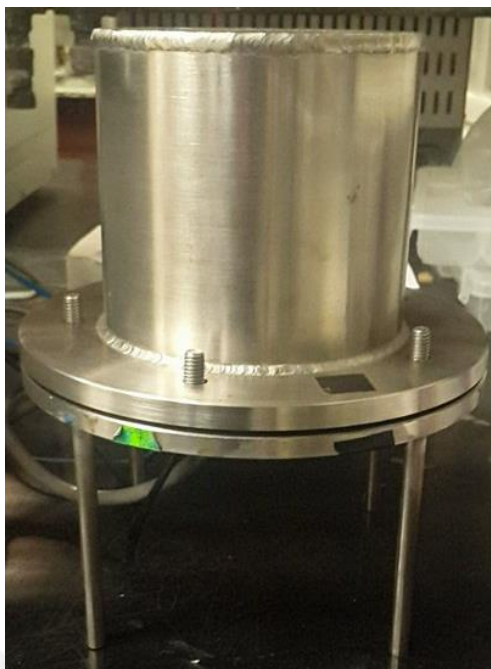
Figura 13. Cámara diseñada donde se ubicó la nariz electrónica
