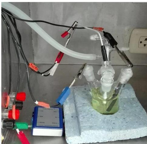
Figura 22. Celda de tres electrodos
