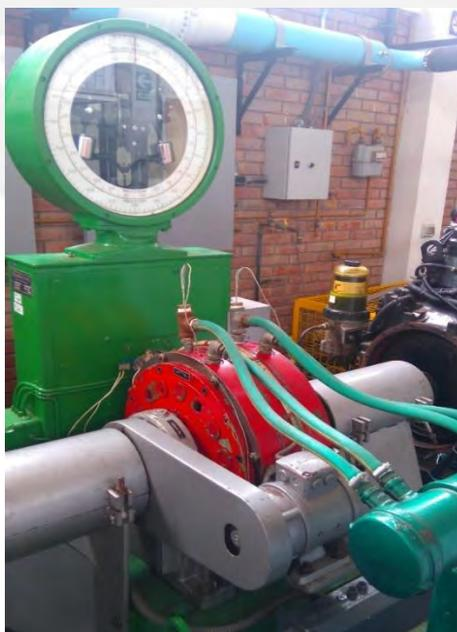
**Figura 13. Dinamómetro utilizado en las pruebas.**
