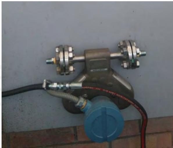
**Figura 24. Medidor de flujo de combustible.**
