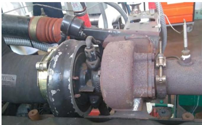
**Figura 12. Sobre-alimentador del motor Diesel.**
