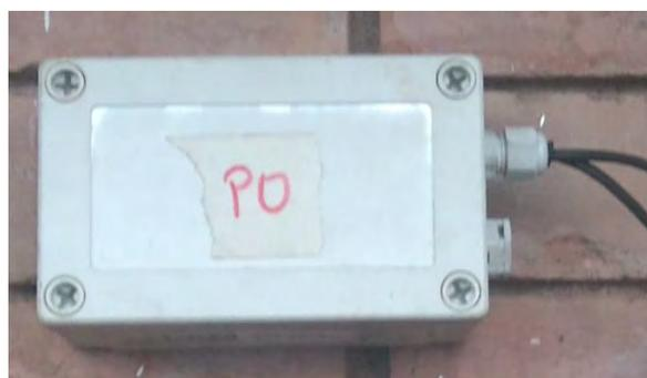
Figura 26. Medidor de presión barométrico.
