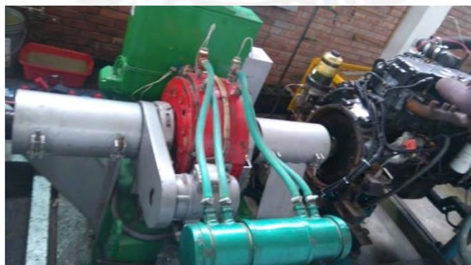
**Figura 17. Sistema de refrigeración del dinamómetro.**
