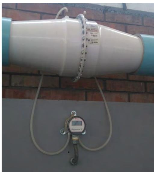
Figura 27. Sensor de presión diferencial y medidor de flujo de aire.
