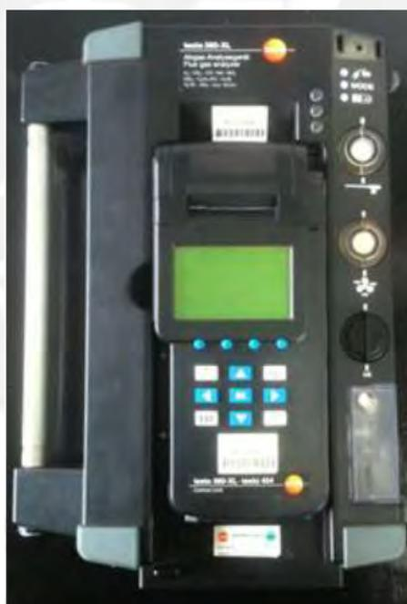
**Figura 22. Analizador de gases.**
