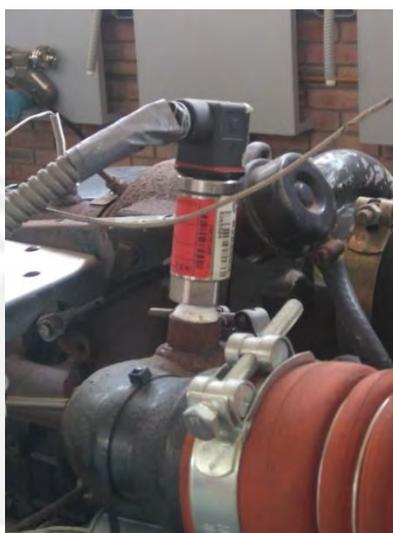
**Figura 29. Sensor de presión para altas presiones.**
