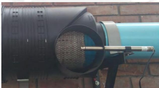
**Figura 23. Sensor de humedad relativa y temperatura instalado antes del filtro de aire.**
