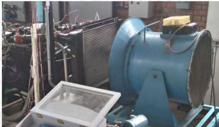
**Figura 21. Sistema de refrigeración de la mezcla de admisión.**
