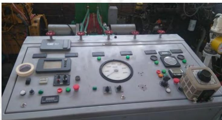
Figura 18. Módulo de control del motor y dinamómetro.
