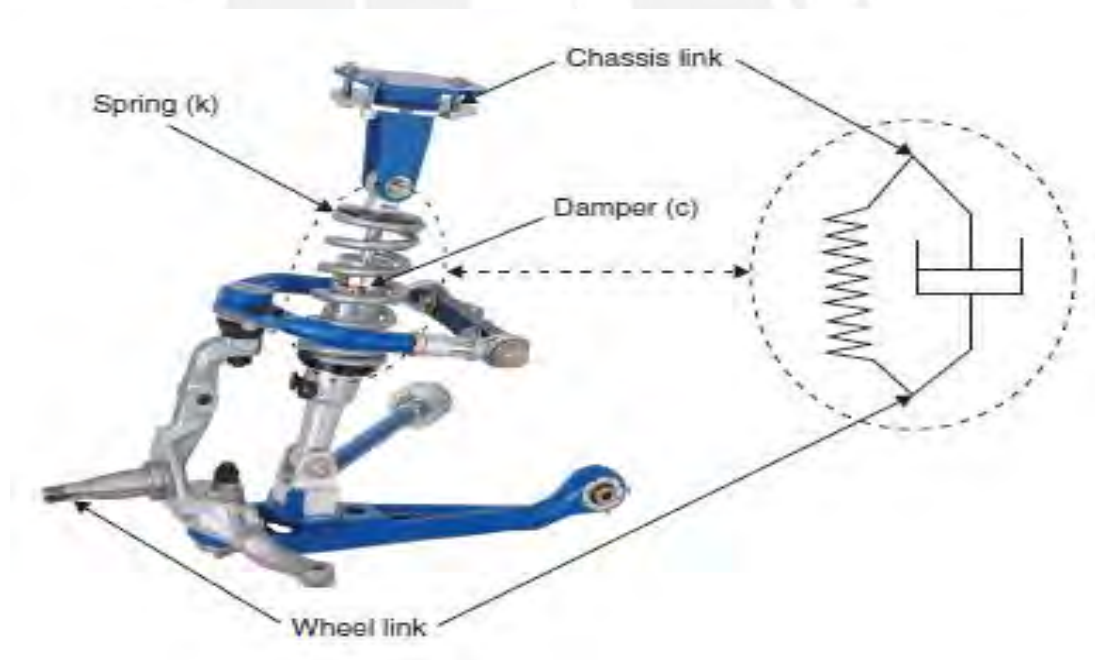
Figura 2.1. Esquema de una suspensión en un vehículo (Savaresi et al , 2010).
