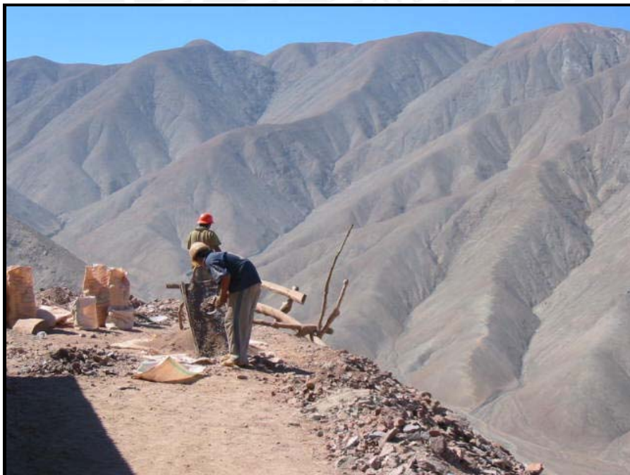
Foto 6 Trabajo minero en Relave, en la vista se puede observar el proceso de “pallaqueo”
