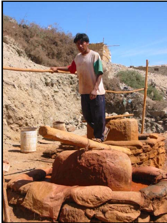
Foto 3 Sistema de trabajo denominado “quimbaletío”, el color rojizo se debe al contenido de mercurio, agua y oro
