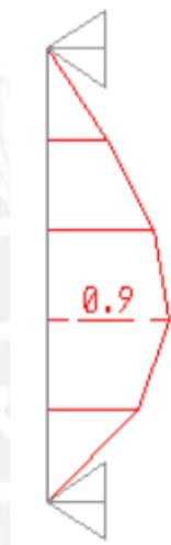
**Figura 48.** Diagrama de momento flector del muro de cisterna (Tn-m)
