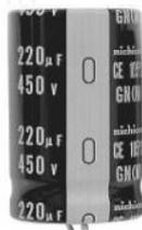
Figura 5.5 Capacitor para la carga no lineal propuesta.
