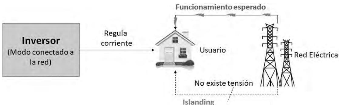
Figura 1.3 Esquema de funcionamiento de un sistema fotovoltaico convencional en modo conectado a la red.
