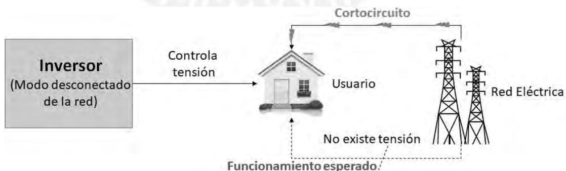
Figura 1.4 Esquema de funcionamiento de un sistema fotovoltaico convencional en modo desconectado de la red.
