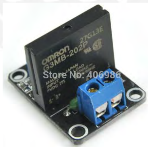
Figura 3.9 Módulo de Relé de estado sólido G3MB-202P – 1 Relé
