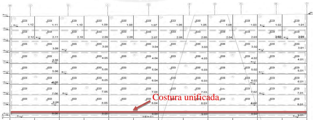
Fig. 7.2 Muros anclados con modulación de acuerdo a tamaño de sótanos. Se puede apreciar la unificación de las dos costuras.
