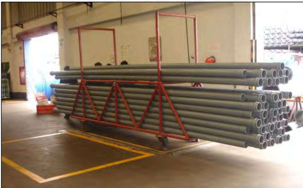
Figura 3: Tubería de presión 110 mm para agua potable con anillo de caucho
