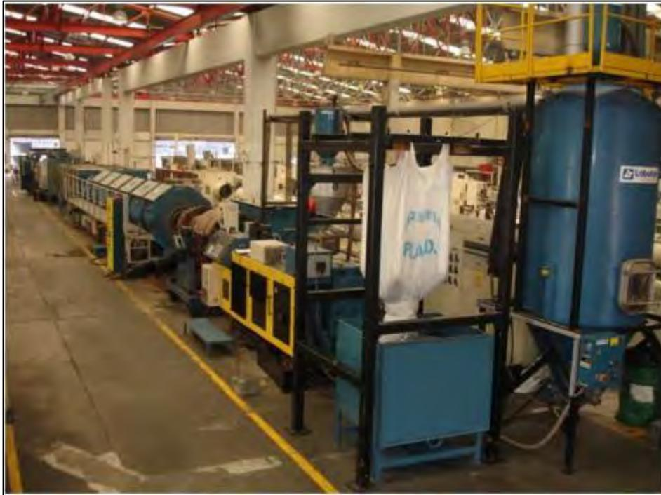
Figura 12: Línea de producción Extrusión Polietileno
