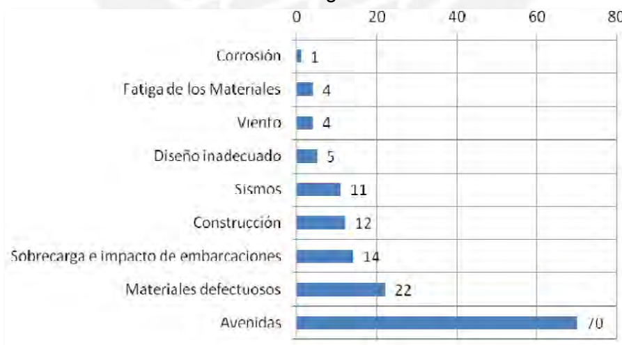
Figura 2.6 Fallas en puentes [4].
