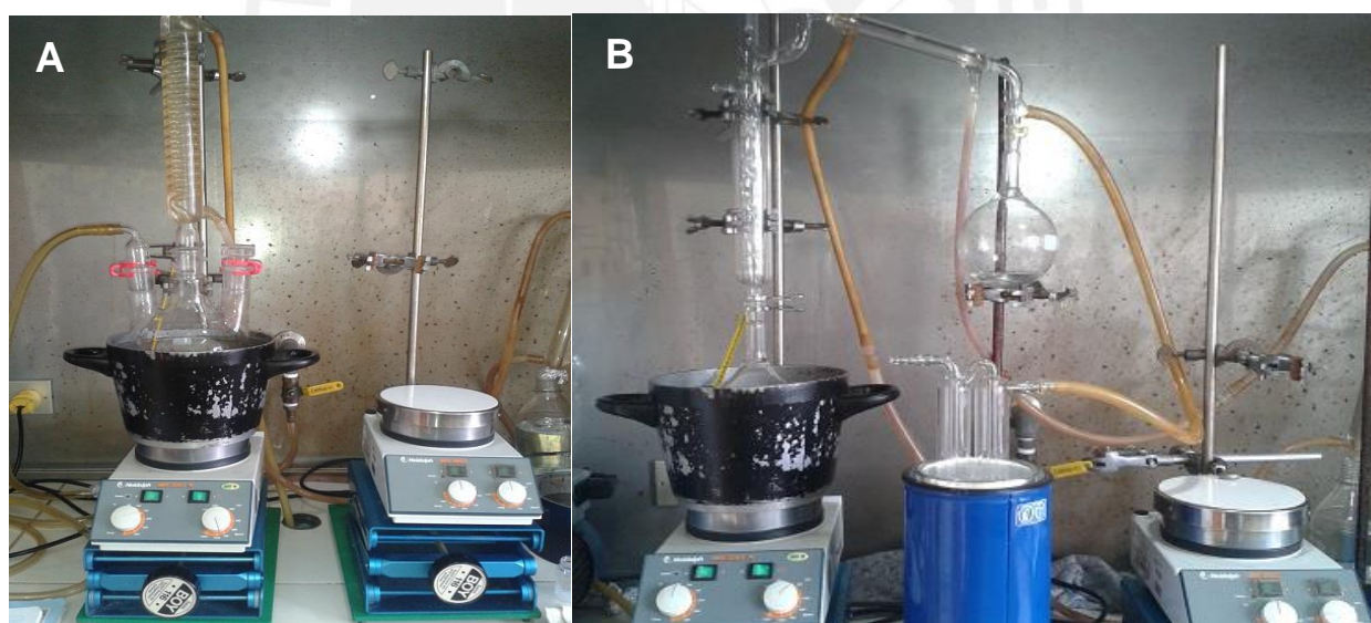
Figura 5.8: (A) Síntesis del monómero: 2-ciclopropil-2-oxazolina, (B) Purificación del monómero.
