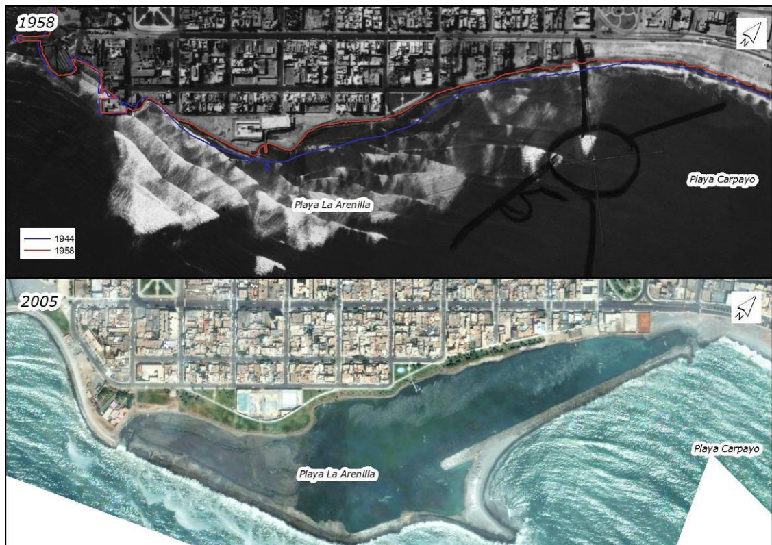
Fig. 39: Pérdida de playa por retroceso de la línea de costa y posterior construcción de rompeolas playa La Arenilla (SAN 1944, SAN 1958, DigitalGlobe 2005).
