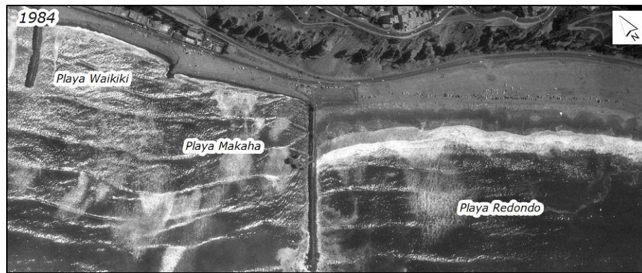
Fig. 22: Extenso espigón norte de la playa Redondo evitó que proceso de arenamiento alcance las unidades al norte de este; obsérvese en Redondo una bien desarrollada playa de arena en contraste con playas Makaha y Waikiki compuestas por cantos rodados y guijarros (SAN 1984).
