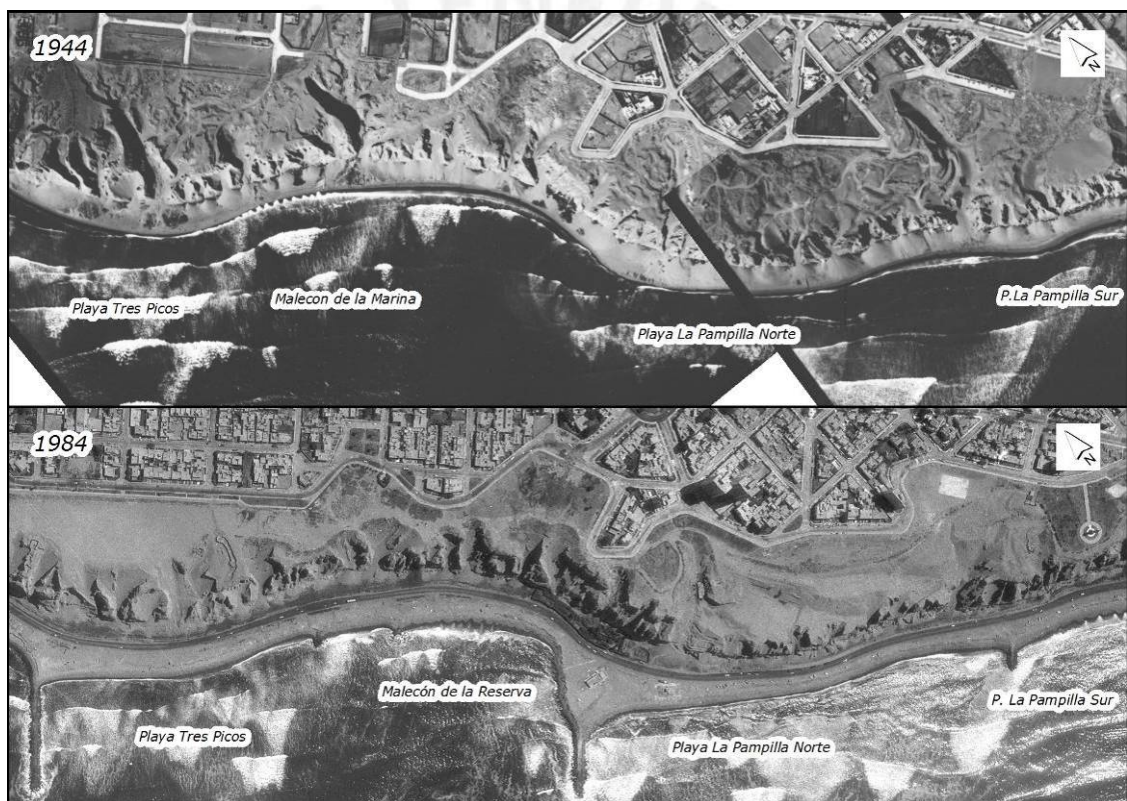
Fig. 26: Sección de mayor espesor del acantilado costero entre playas La Pampilla Norte y Tres Picos, donde los conos de derrubios son los más desarrollados; estos proporcionaron materiales para la construcción del terraplén. (SAN 1944, SAN 1984).
