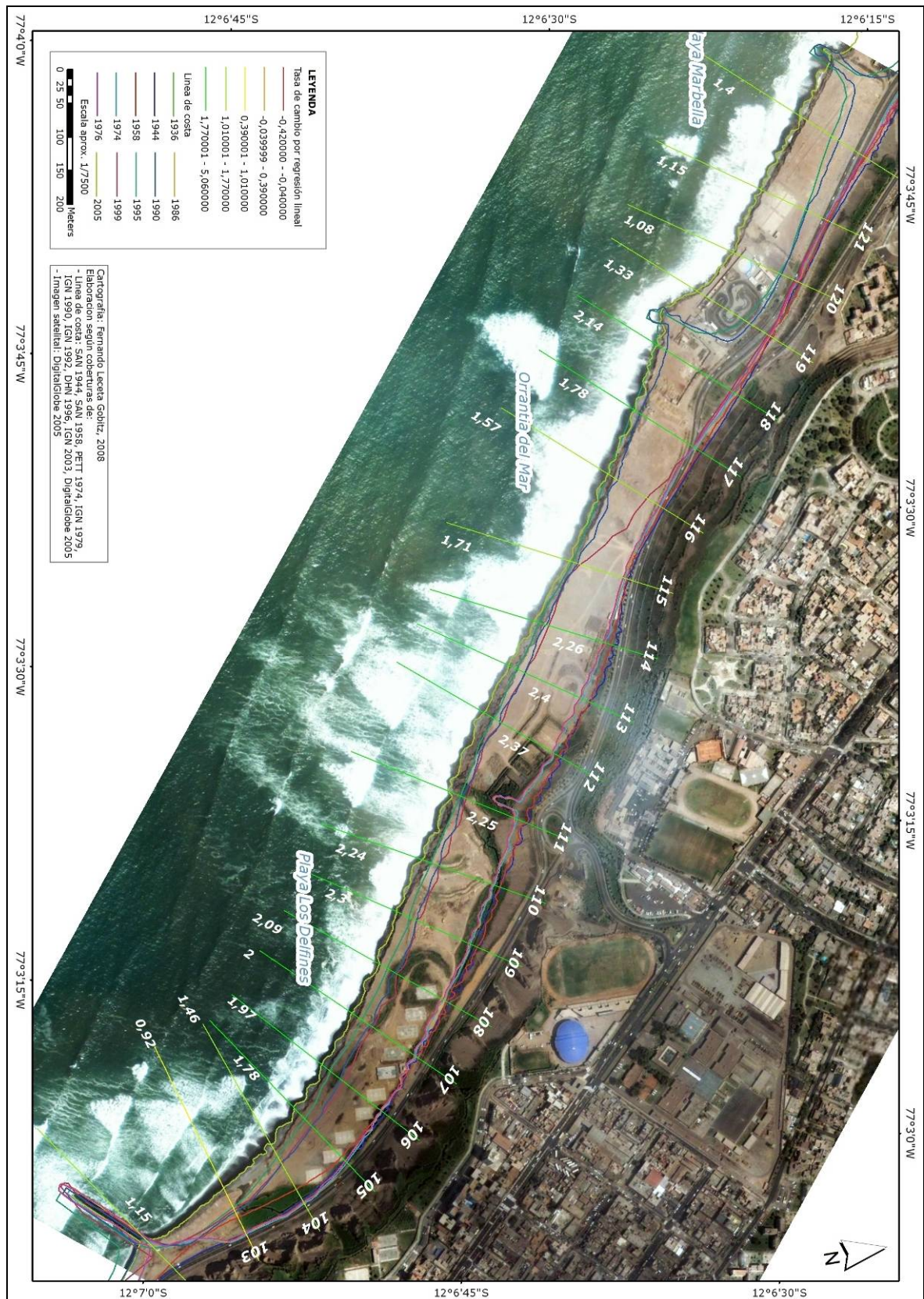
Fig. 29: Variación temporal de la línea de costa y tasas de cambio según regresión lineal sector playas Los Delfines, Orrantía del Mar y Marbella 1944-2005.
