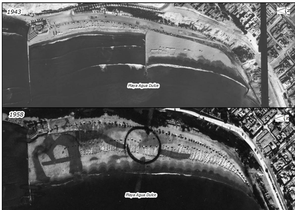
Fig. 12: Área ganada durante el periodo 1944-1958 exclusivamente por sedimentación arenosa, se advierte el espigón sur colmatado al final del periodo (SAN 1943, SAN 1958).
