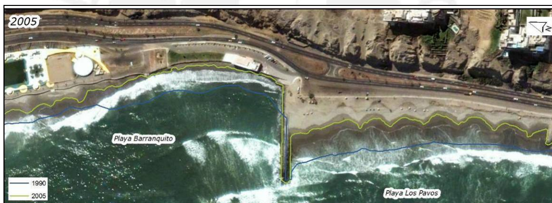
Fig. 18: Repliegue de la costa entre 1990-2005 en unidades Barranquito y Los Pavos muestra pérdida de área de playa luego de posición de máximo avance (IGN 1992, DigitalGlobe 2005).
