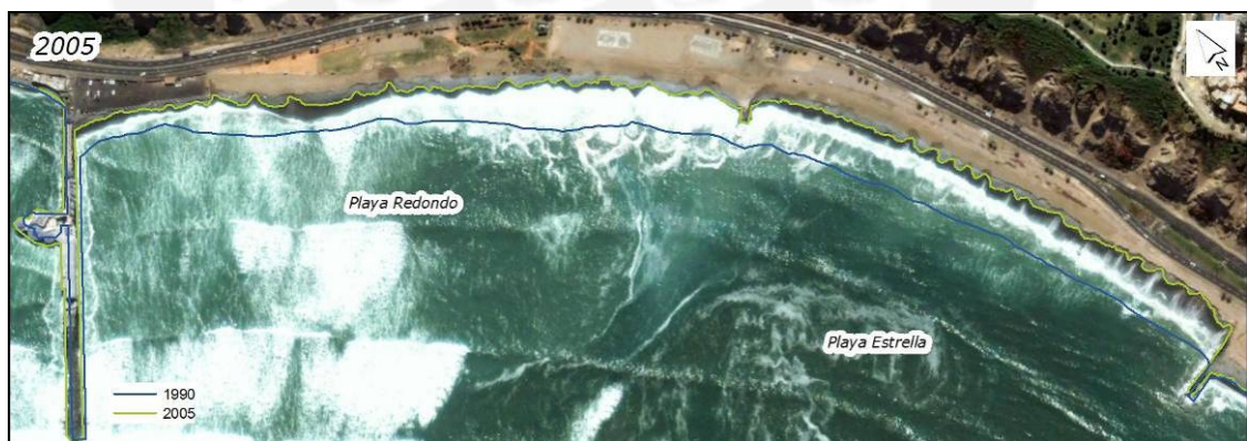
Fig. 24: Paralelo playas Estrella y Redondo entre posición cercana al máximo avance y posición de máximo repliegue (IGN 1992, DigitalGlobe 2005).
