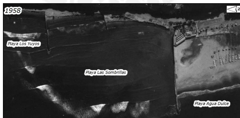
Fig. 14: Contraste entre el lento desarrollo de la playa Sombrillas y su ubicación respecto al espigón norte de la playa Agua Dulce (SAN 1958).
