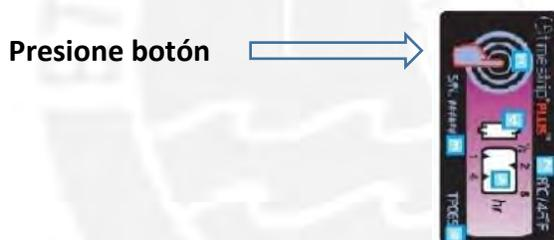
**Figura 18. Activación de indicador de control de temperatura**
