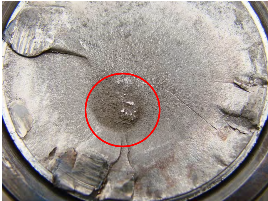
Fig. 3.21 - Zona de fractura final de eje de reductor de bomba
