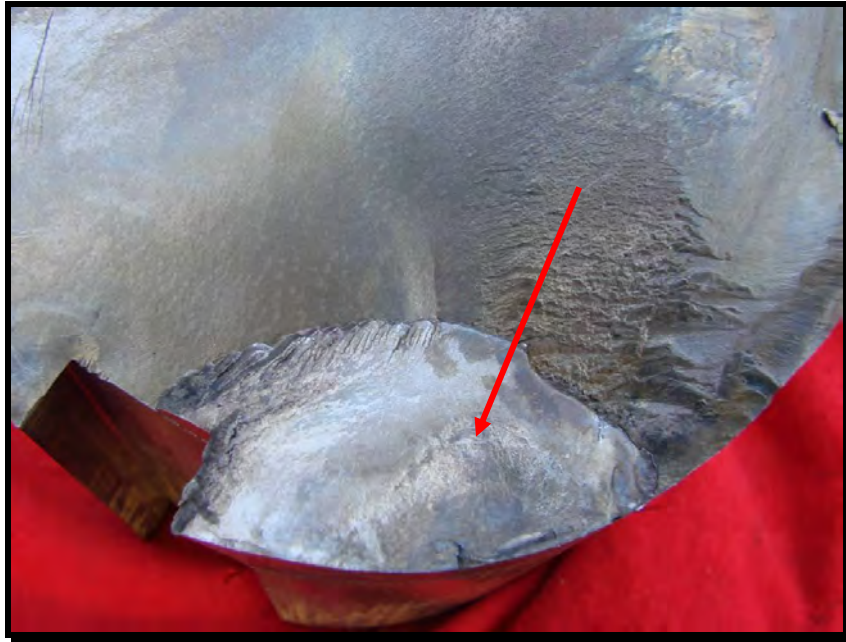
Fig. 3.33 - Inicio de fisura de frote de propagación 2
