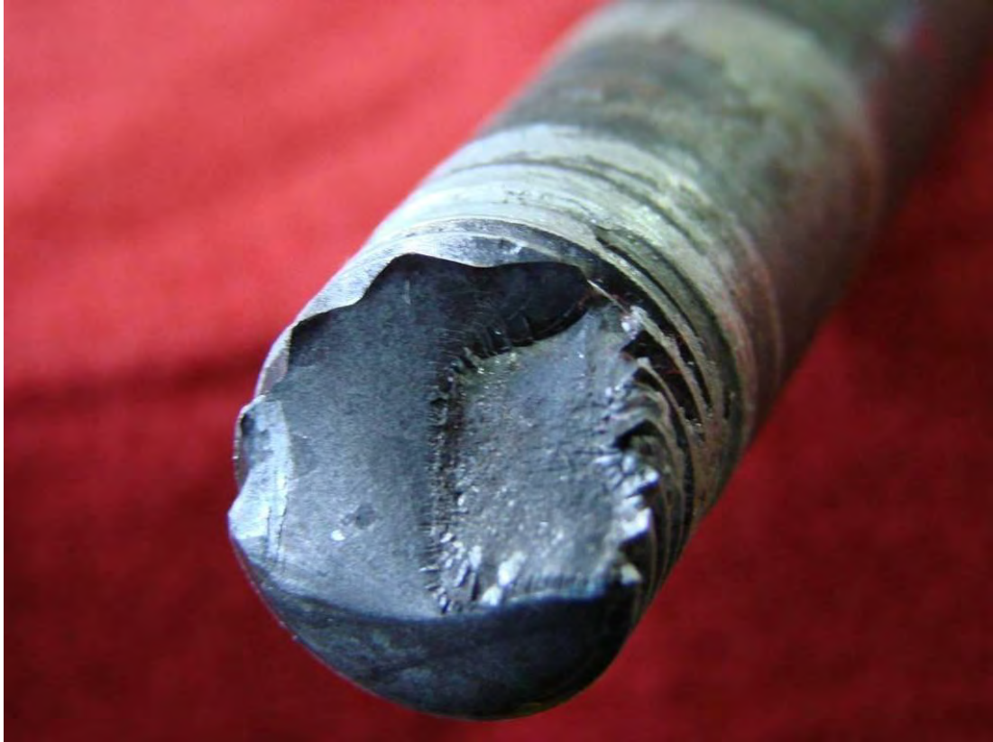
Fig. 3.42 - Superficie de fractura zona roscada. Propagación a 45° respecto al eje axial
