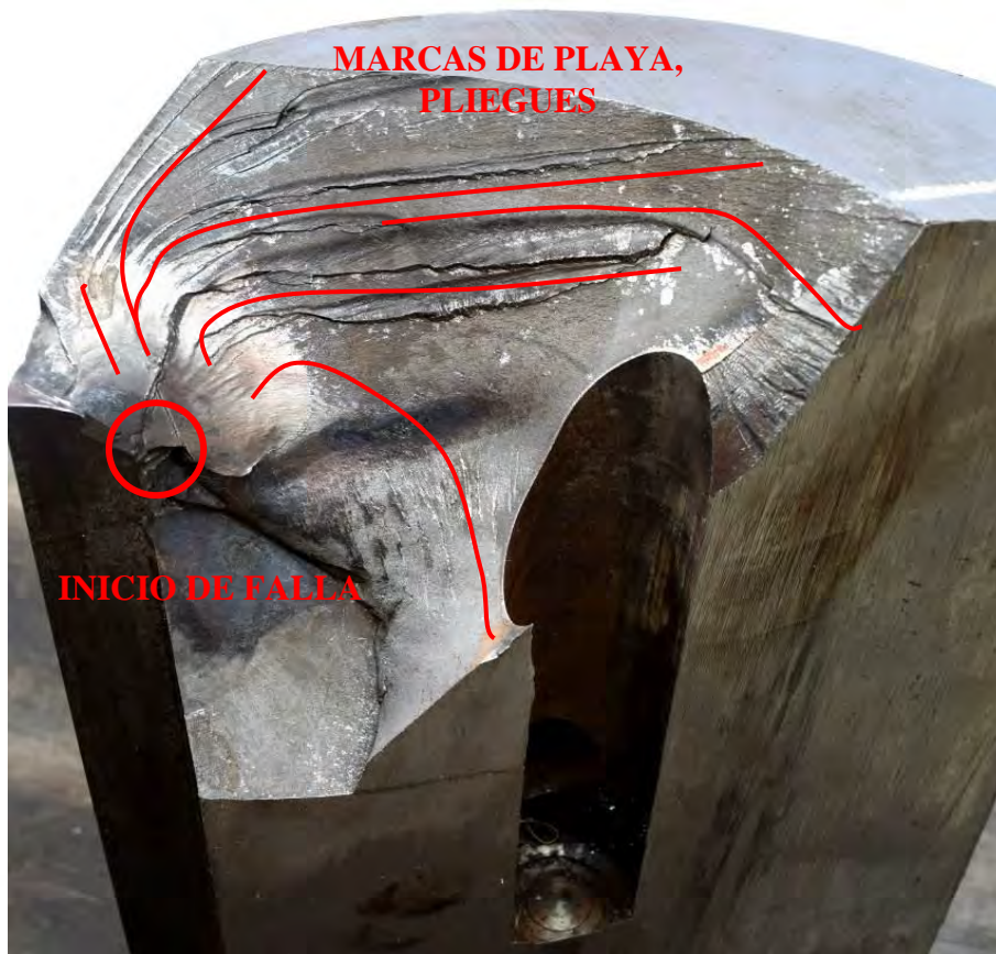
Fig. 3.5 - Superficie de Fractura
