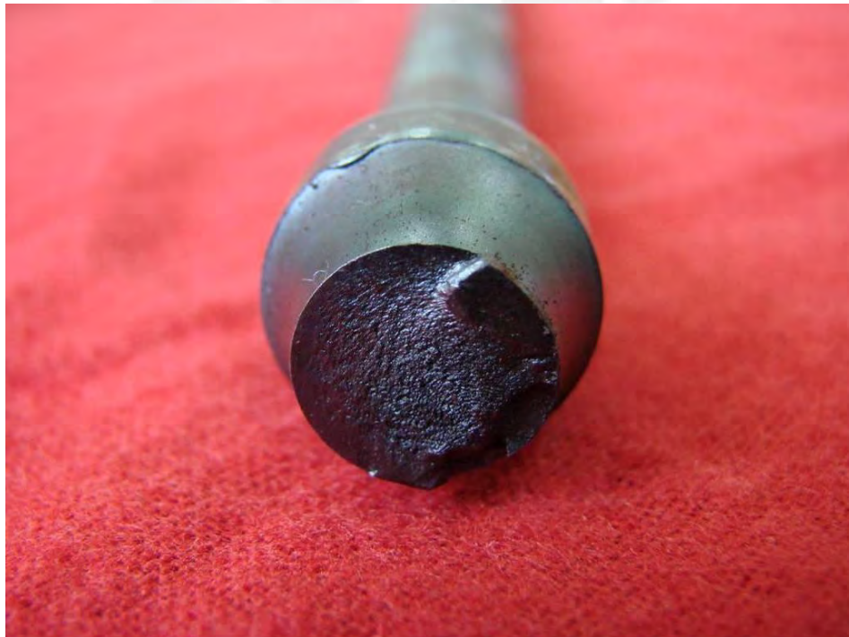
Fig. 3.41 - Superficie de fractura zona cilíndrica
