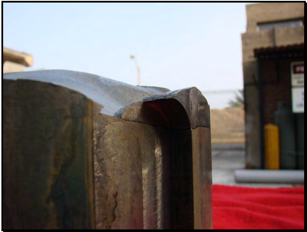
Fig. 3.35 - Acabado superficial de fondo de canal chavetero
