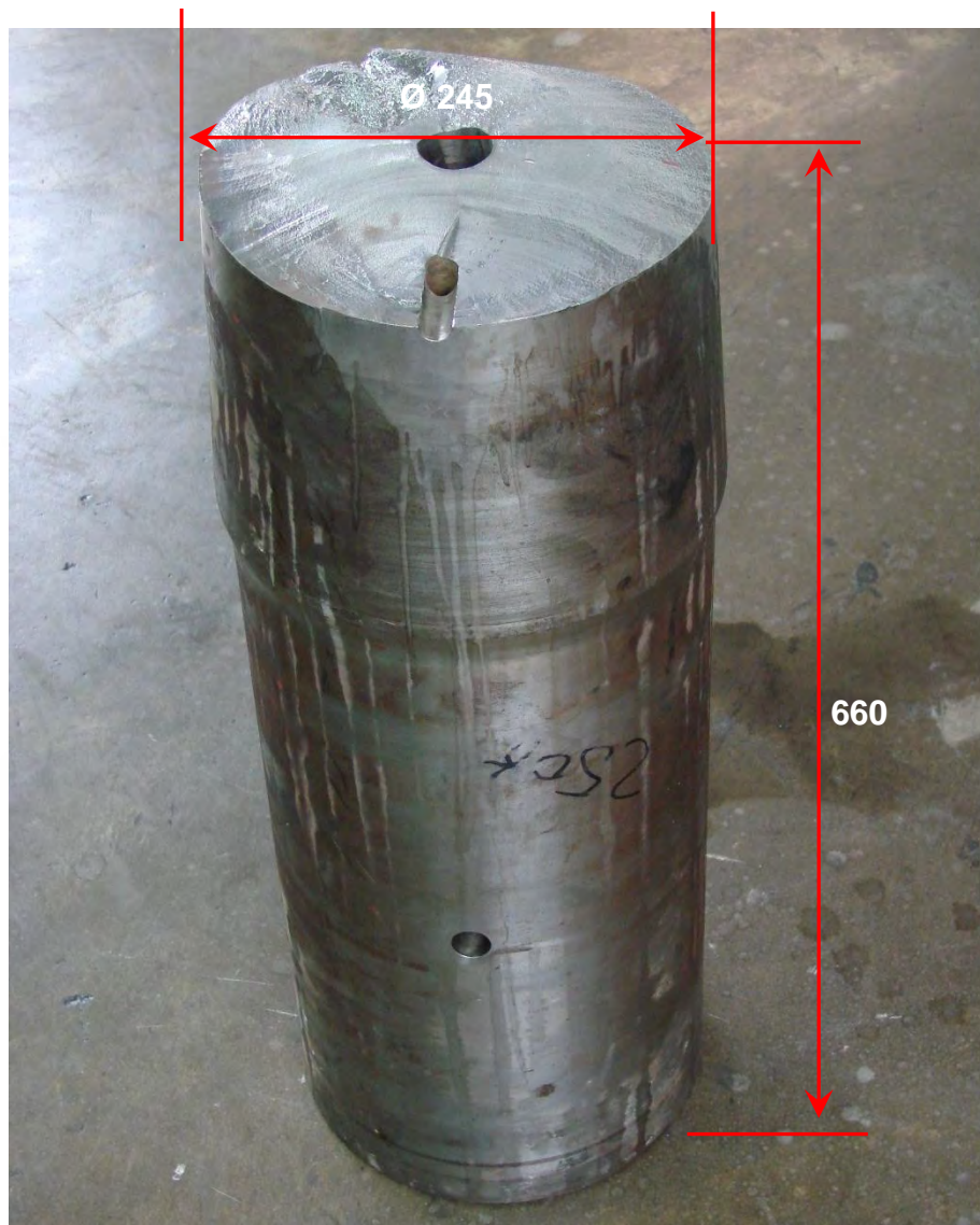
Fig. 3.66 - Eje Principal de trituradora
