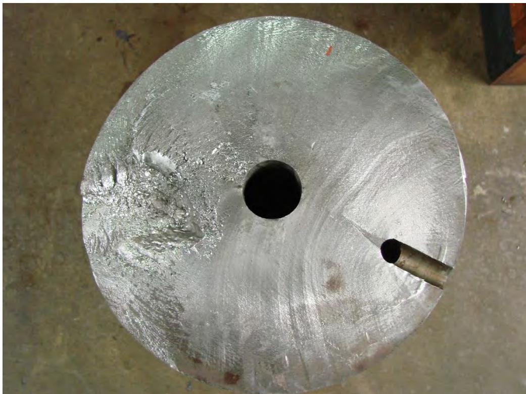
Fig. 3.67 - Superficie de fractura de eje principal de trituradora
