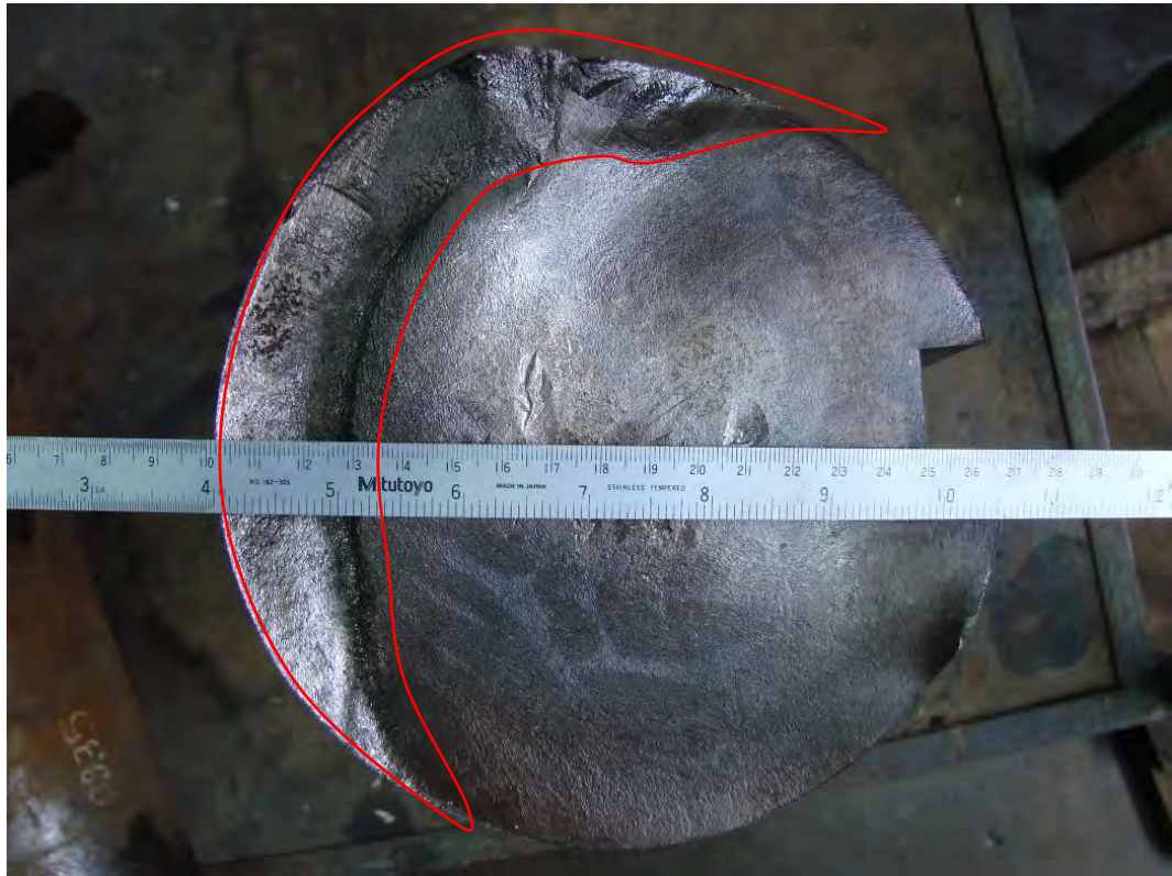
Fig. 3.60 - Superficie de Fractura sin deformación plástica. Rotura final
