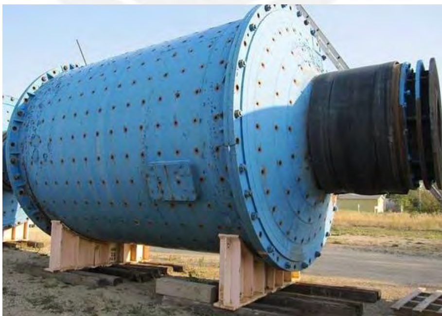
Fig. 3.1 - Molino de bolas Dominion
