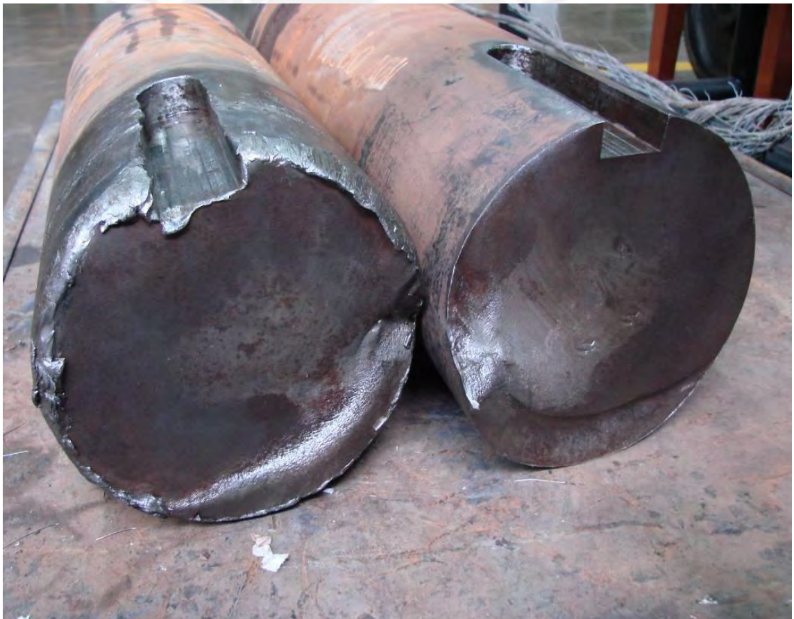
Fig. 3.59 - Superficies de fractura de ambas partes del eje del sistema de izaje
