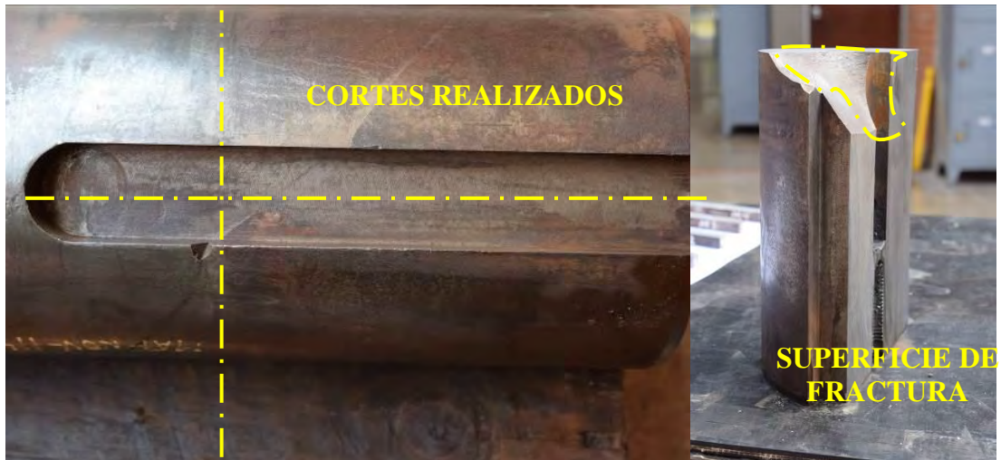
Fig. 3.13 - Corte realizado para inspección visual en Eje FALK N°2
