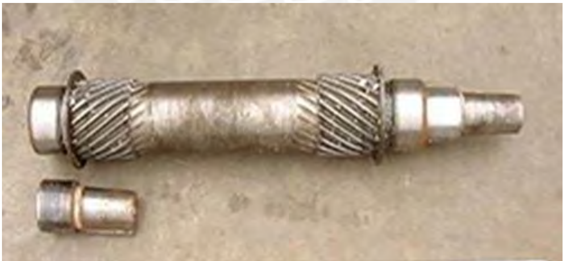
Fig. 3.19 - Eje de caja reductora de bomba
