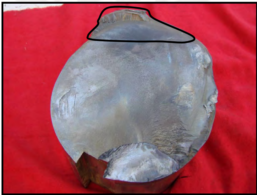
Fig. 3.34 - Superficie de fractura. Zona de rotura final
