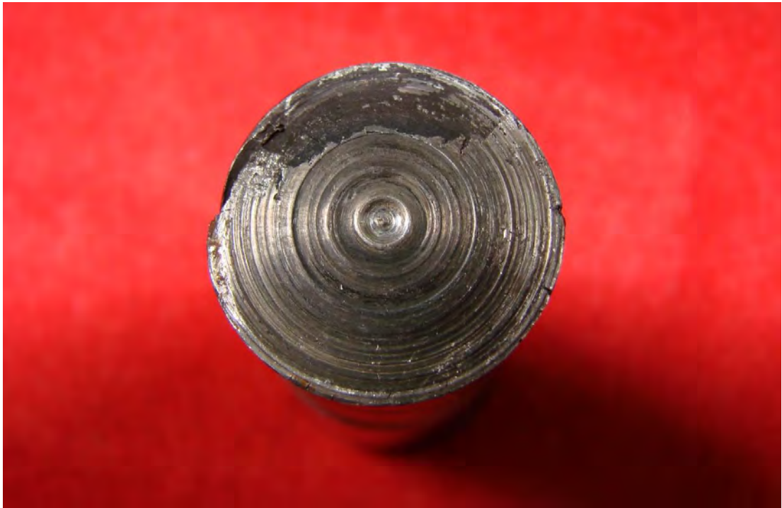
Fig. 3.71 - Superficie de ataque a eje inoxidable
