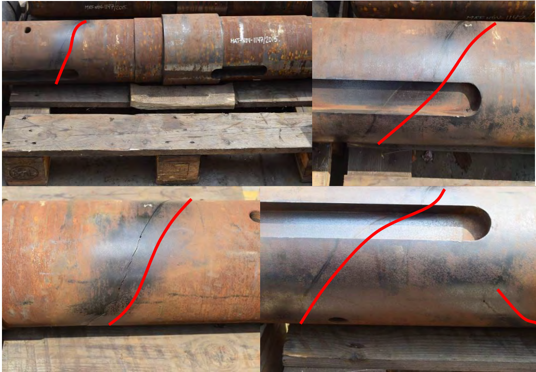
Fig. 3.3 - Fisura de Eje Falk N°1
