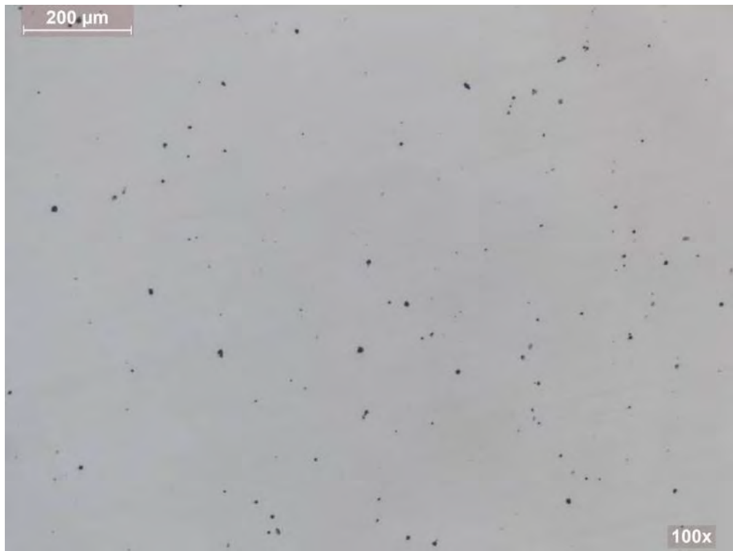
Fig. 3.16 - Micrografía de la zona afectada, sin ataque a 100x
