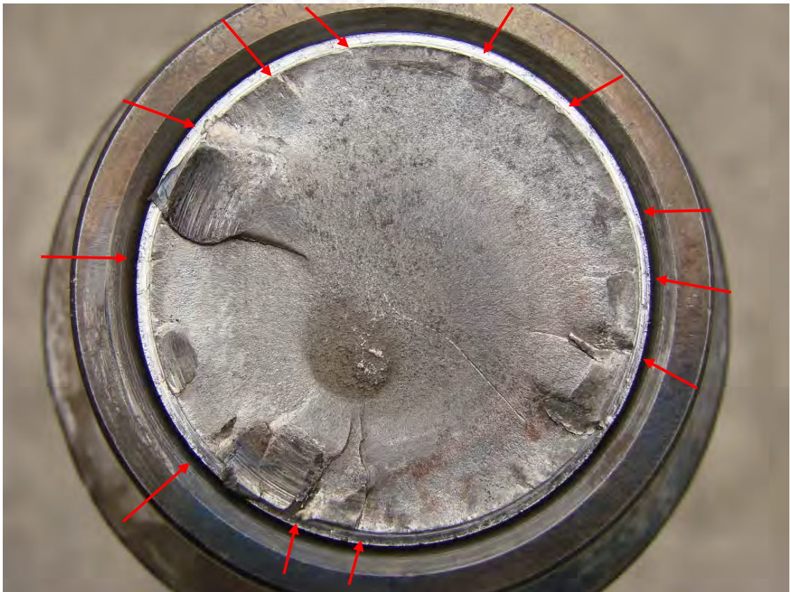
Fig. 3.20 - Superficie de fractura eje de caja reductora de bomba
