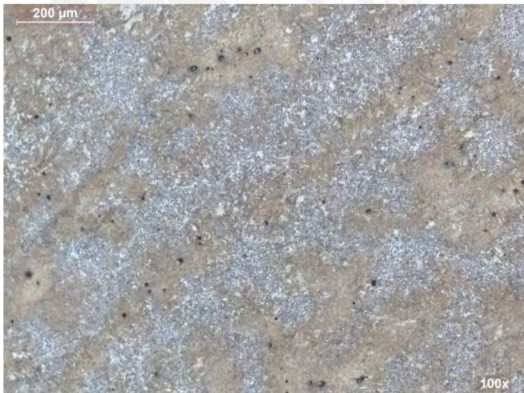
Fig. 3.17 - Micrografía de la zona afectada, con ataque a 100x
