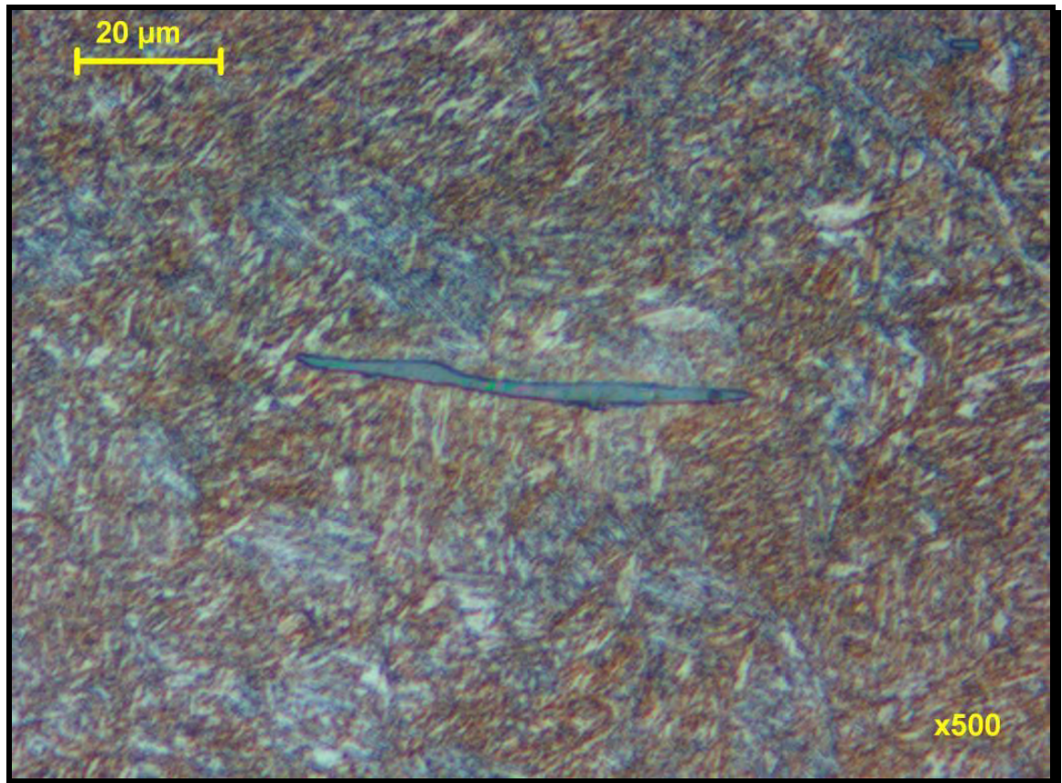
Fig. 3.38 - Micrografía de la zona afectada con ataque a 500x
