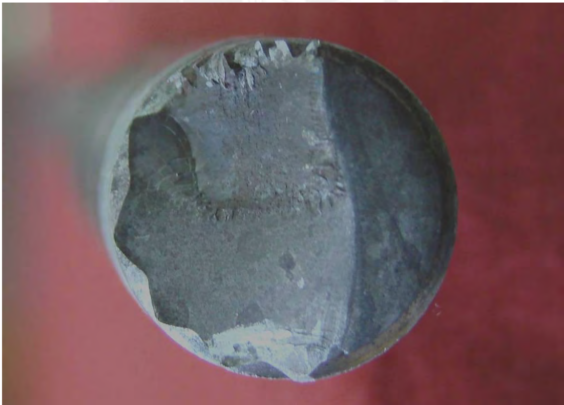
Fig. 3.43 - Superficie de fractura de la zona roscada. Zona de rotura final
