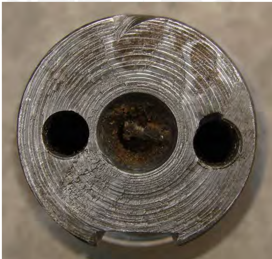
Fig. 3.22 - Acabado superficial de un extremo del eje con huellas del mecanizado
