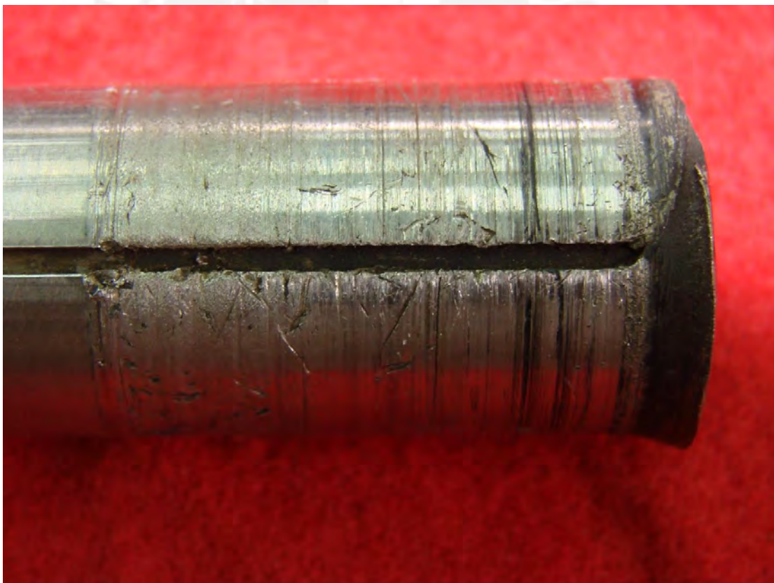
Fig. 3.72 - Canal chavetero de eje inoxidable
