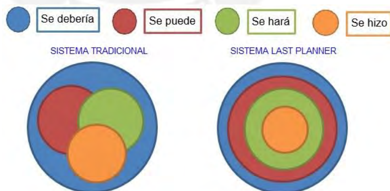
Fig. 3.2.1.1 Sistema tradicional vs Sistema Last Planner. Fuente: Elaboración propia
