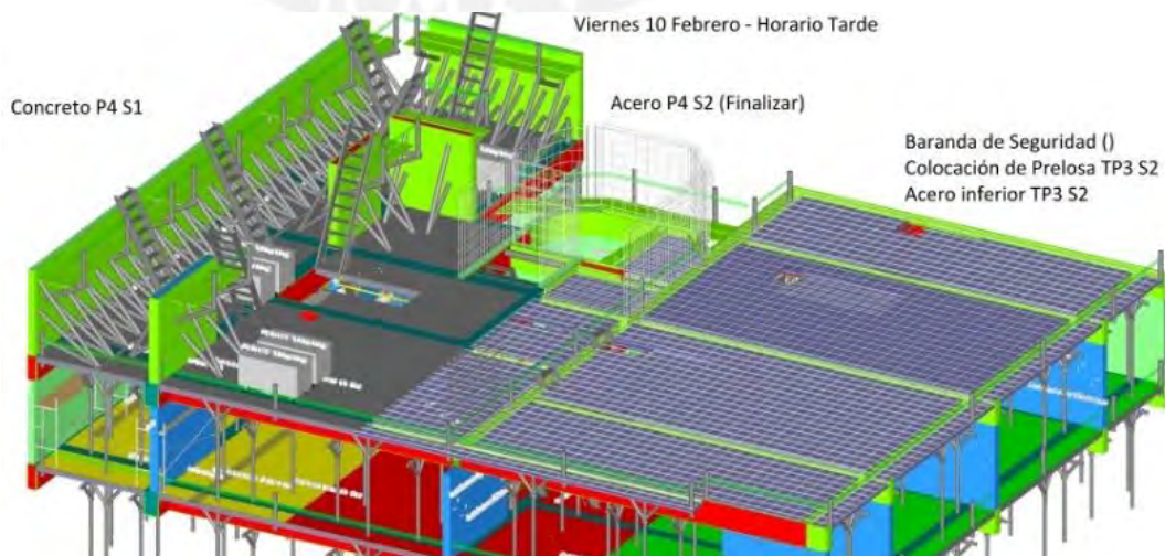
Fig. 3.1.3.2.1 Visualización del modelo con información virtual. Fuente: Elaboración propia
