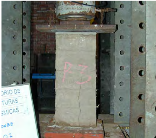
Figura 4.7. Ensayo a compresión axial
