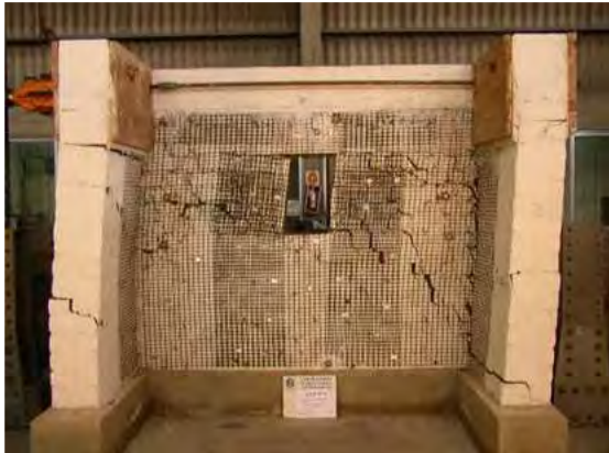
Figura 4.13. Muro con geomalla después del ensayo
