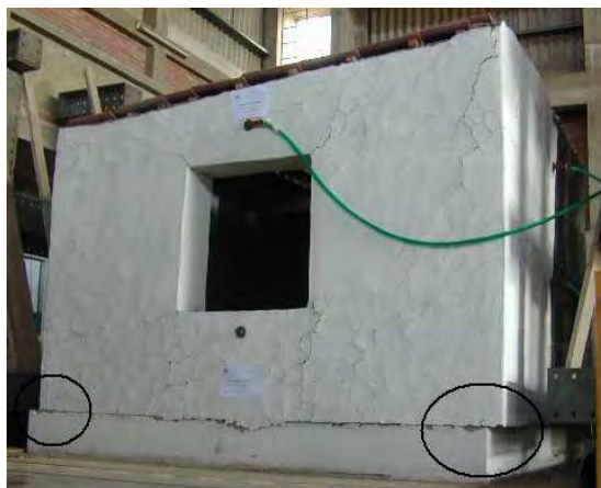
Figura 3.17 Desplazamiento del muro en A1 del M5 (Geomalla)
