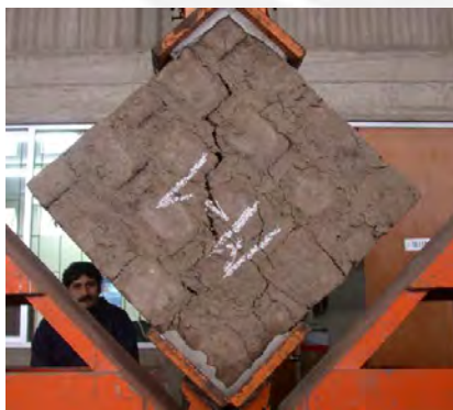
Figura 4.8. Ensayo a compresión diagonal
