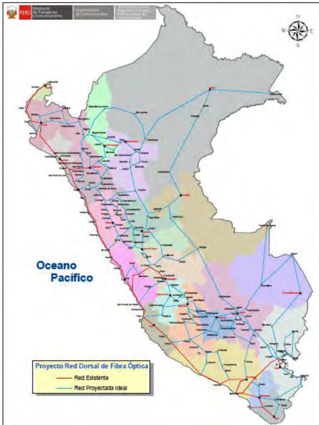
Figura 52. Proyecto Red Dorsal de Fibra Óptica Tomado de Comisión Red Dorsal de Fibra Óptica , por MTC, 2016c ( http://www.mtc.gob.pe/portal/fibraoptica/RED_DORSAL_IDEAL_VF.pdf )
