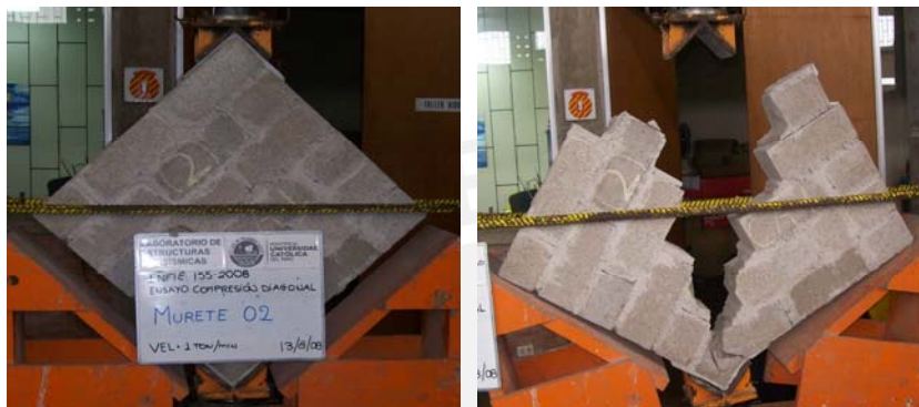
Fig. 3.21 - Falla del Murete 02
