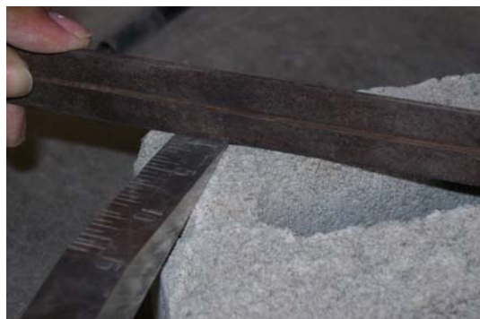
Fig. 2.3.- Ensayo de alabeo
