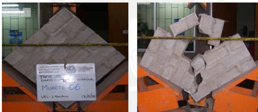
Fig. 3.25 - Falla del Murete 06
