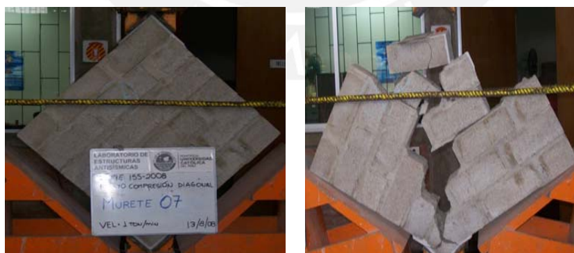
Fig. 3.26 - Falla del Murete 07
