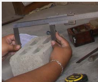
Fig. 2.2.- Prueba de variabilidad dimensional
