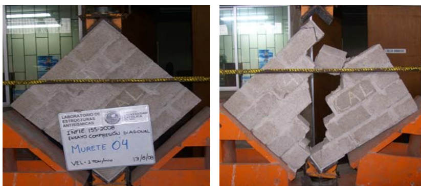
Fig. 3.23 - Falla del Murete 04
