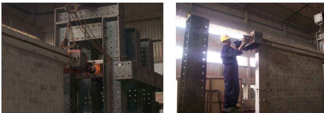
Fig. 6.4.- Actuador dinámico y tirante para aplicar cargas negativas
