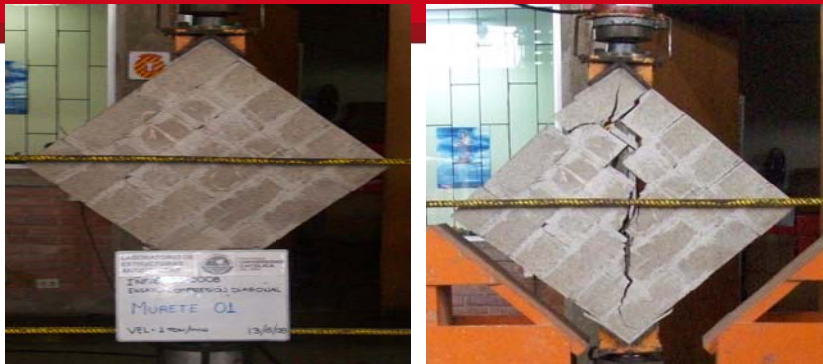
Fig. 3.20 - Falla del Murete 01
