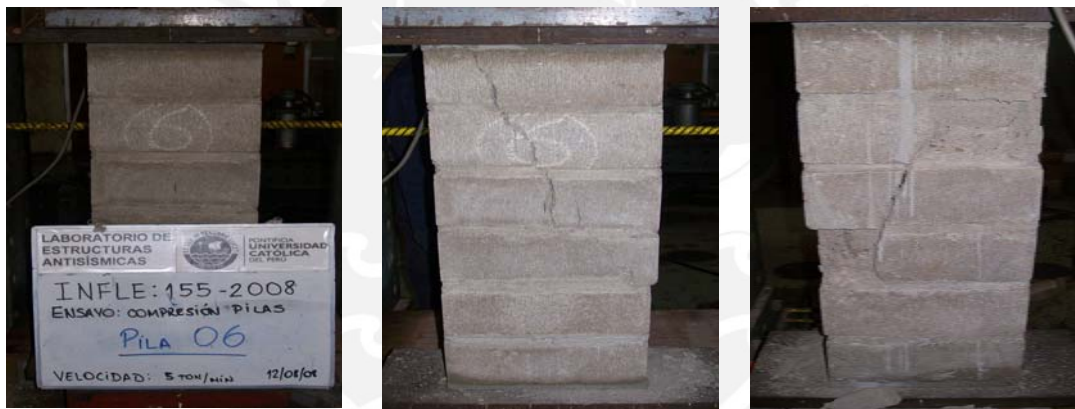
Fig. 3.12 - Falla de la Pila 06
