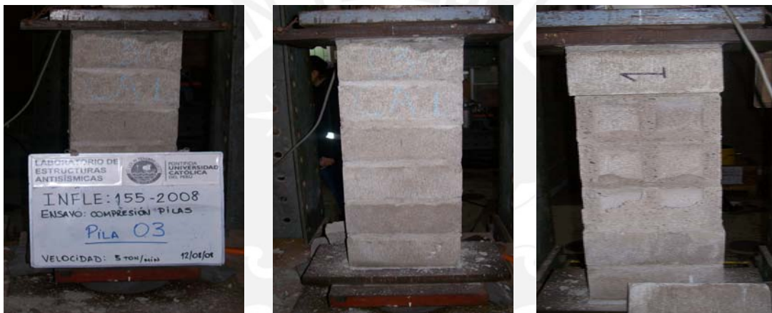
Fig. 3.9 - Falla de la Pila 03
