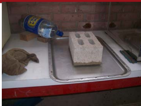
Fig. 2.6.- Ensayo de Succión
