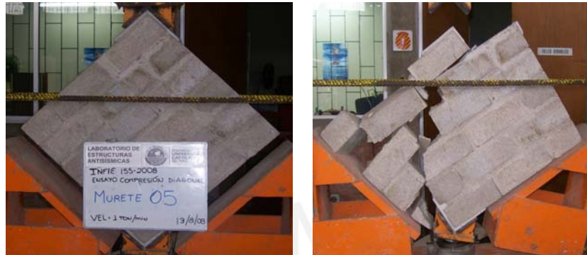
Fig. 3.24 - Falla del Murete 05
