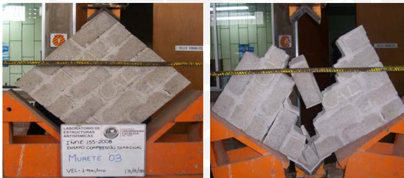
Fig. 3.22 - Falla del Murete 03
