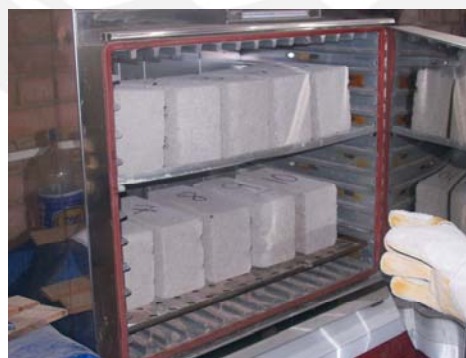
Fig. 2.5.- Unidades de concreto dentro del horno a 110^\circ\text{C}
