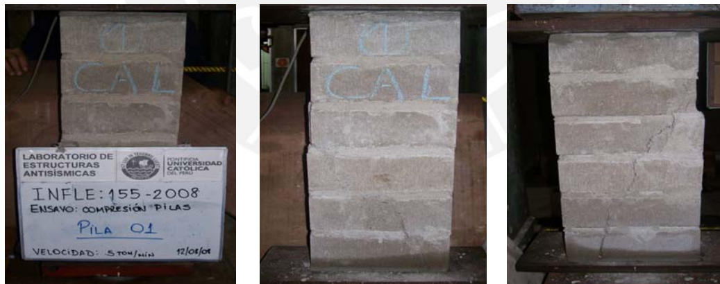
Fig. 3.7 - Falla de la Pila 01
