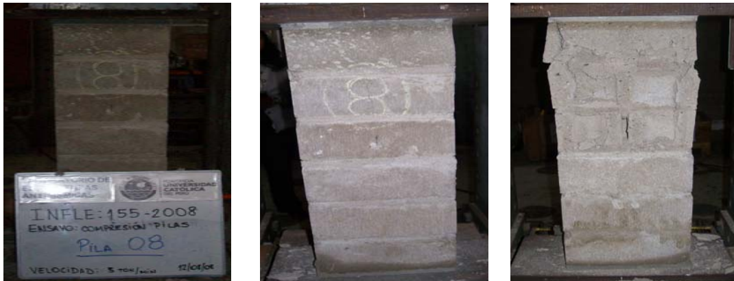
Fig. 3.14 - Falla de la Pila 08
