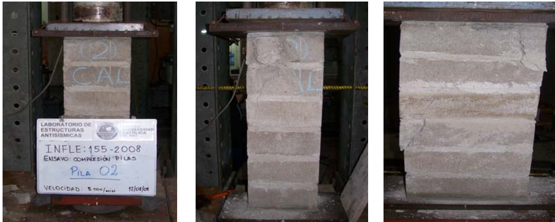
Fig. 3.8 - Falla de la Pila 02
