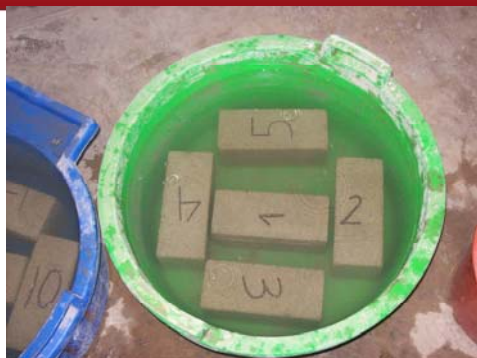
Fig. 2.7.- Unidades de concreto en balde con agua destilada
