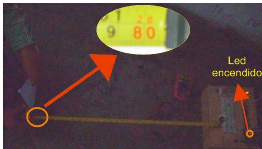
Figura 4.15: Prueba del sensor a una distancia de 80cm, utilizando papel blanco
