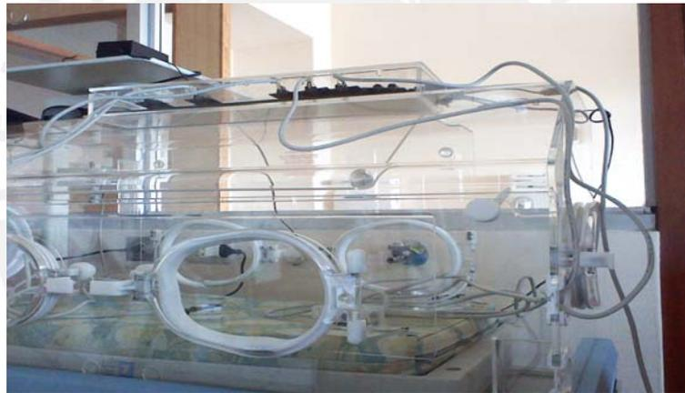
Figura 3.9 Ubicación real del termómetro multicanal en la incubadora neonatal
