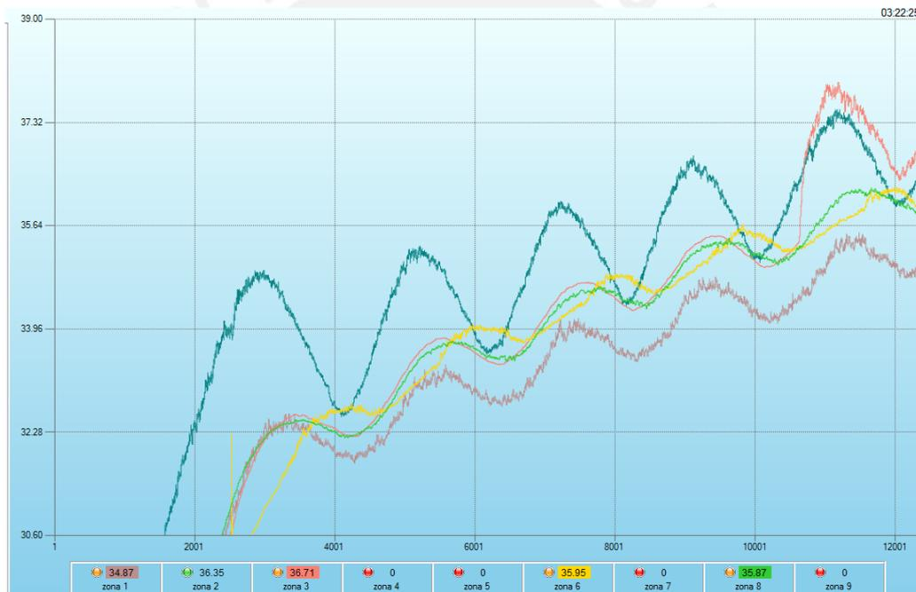
Figura 3.12 Gráfica a tiempo real de la temperatura de cinco puntos internos de la incubadora neonatal con topología de la tabla 3.9
