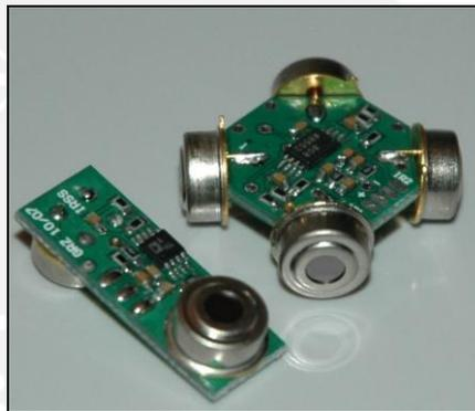
**Figura 2.8.** Paparazzi IR Sensors IR & IRH (Fuente: [18])
