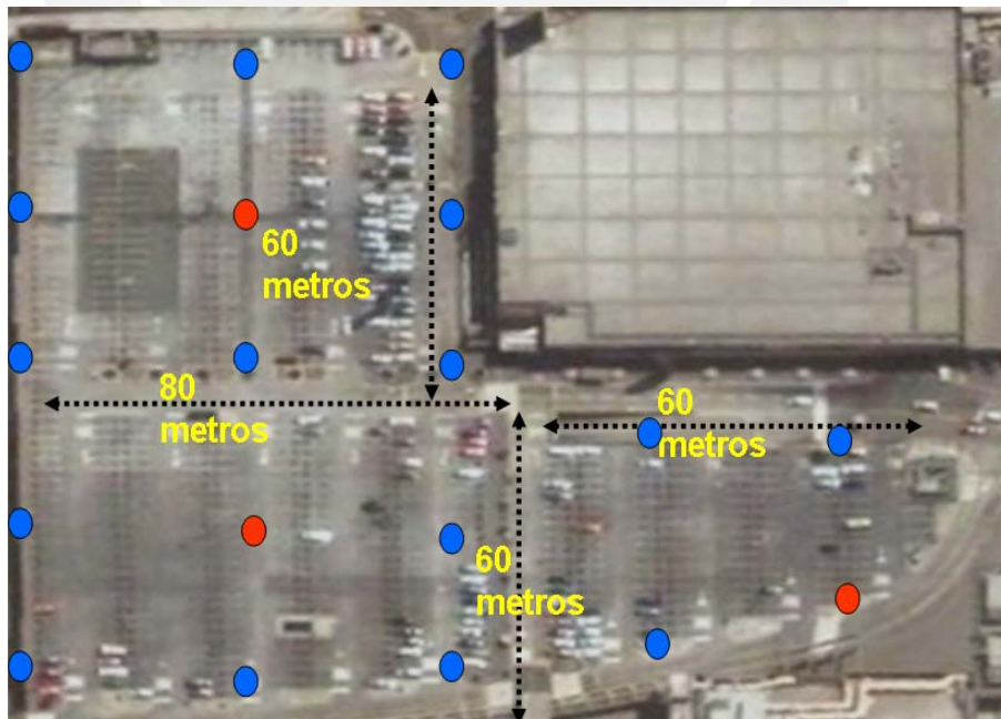
Figura N° 4.18. Segunda zona: Distribución de cámaras
