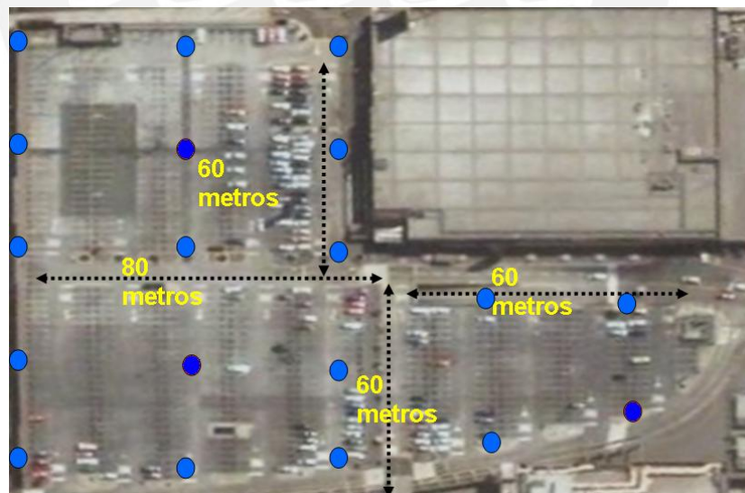
Figura N° 4.15. Segunda zona: Medidas y distribución de postes
