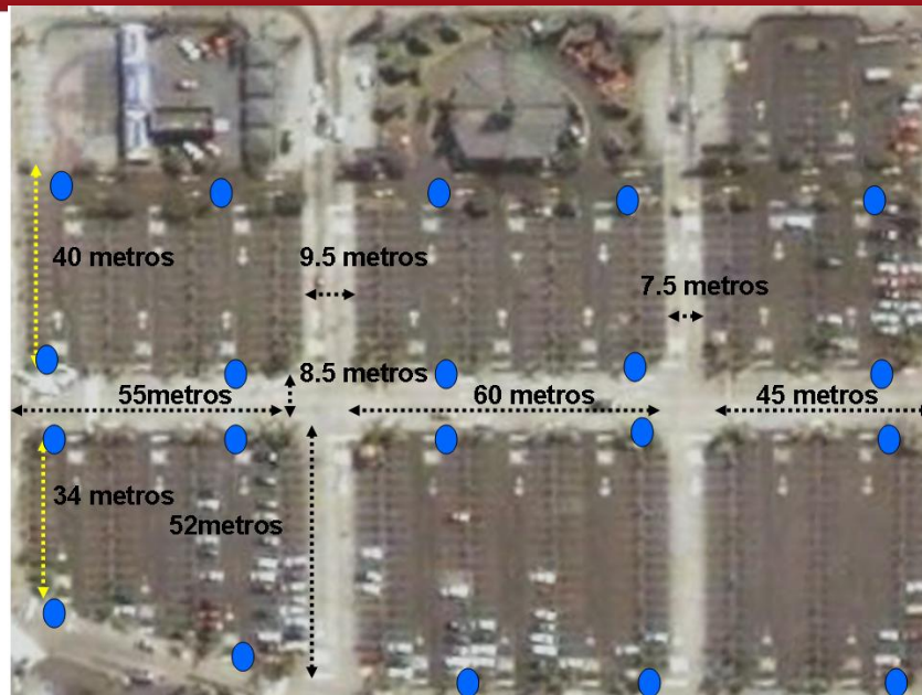
Figura N° 4.14. Primera zona: Medidas y distribución de postes
