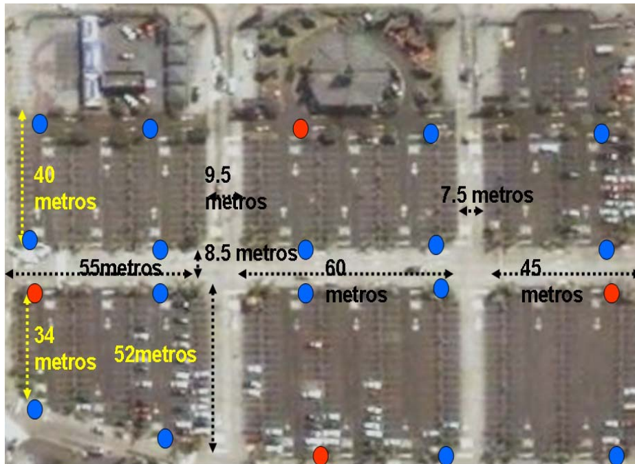
Figura N° 4.17. Primera zona: Distribución de cámaras
