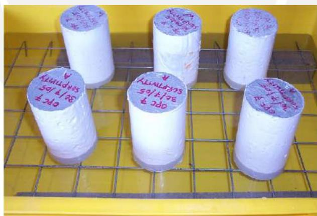
Figure 4.5: Especímenes colocados sobre malla de alambre con la cara de succión bajo agua (Kartini et al, 2010)
