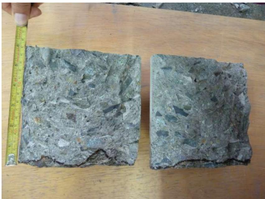
Figure 6.15: Superficie de rotura de la probeta 4 marcada su profundidad de penetración
