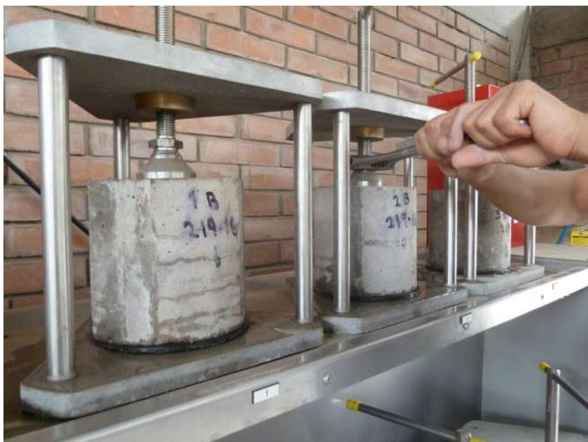
Figure 6.11: El técnico realizando la puesta de la probeta B2 siguiendo la recomendación del manual de presionar la rosca con llave francesa
