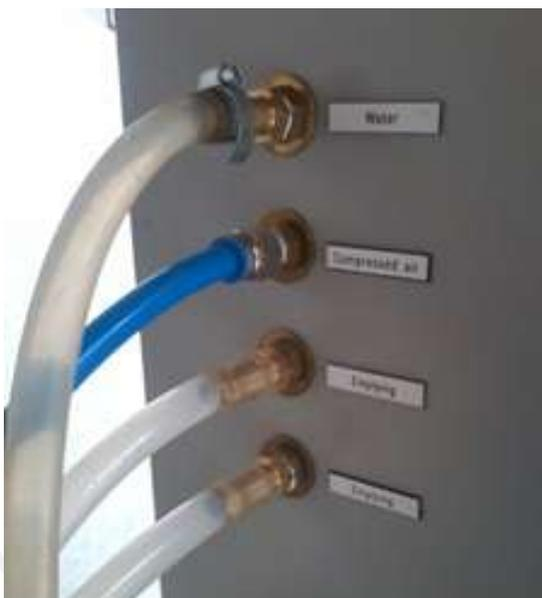
Figure 6.6: Puntos de agua, aire a presión y eliminación de agua conectados a sus mangueras respectivas
