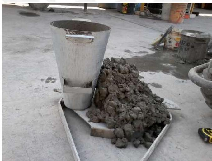
Figure 6.4: Asentamiento por corte del concreto patrón. (Fuente propia)
