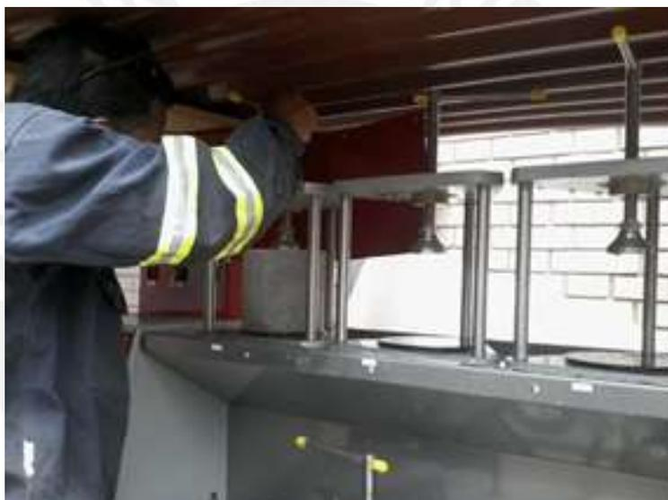
Figure 6.8: Ajuste del perno de sujeción
