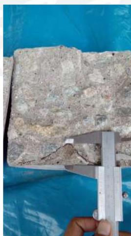
Figure 4.8: Determinación de la profundidad de penetración de agua
