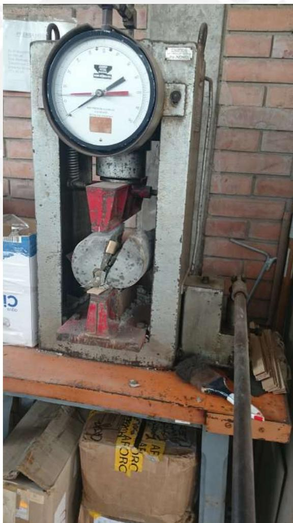
Figure 6.10: Probeta dividida en dos en el equipo de compresión diametral
