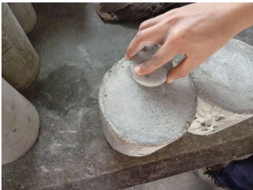
Figure 6.12: Escarificado de base donde se aplicará la presión de agua
