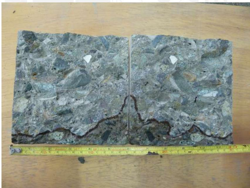
Figure 6.14: Superficie de rotura de la probeta 5 marcada su profundidad de penetración
