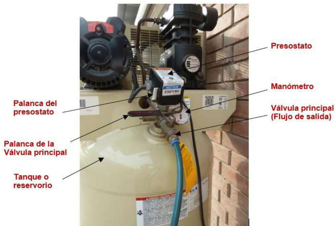
Figure 6.7: El compresor y sus partes
