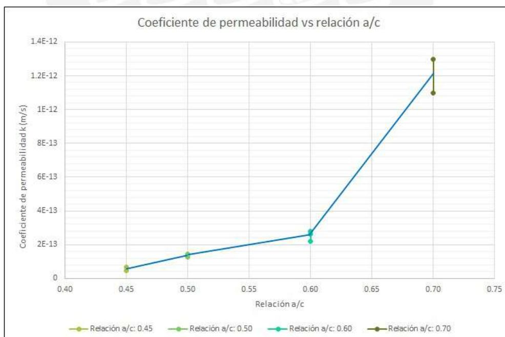
Figure 7.4: Recta de Coeficiente de permeabilidad sin valores atípicos vs Relación agua/cemento
