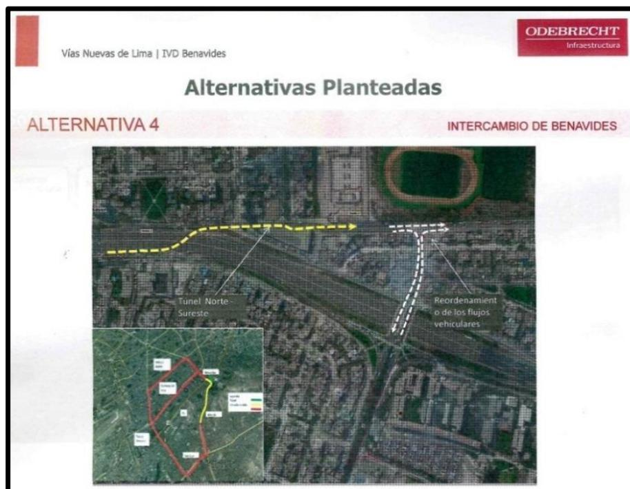
**Foto 15:** Alternativa 04: construcción de 01 túnel subterráneo y reordenamiento vehicular. **Fuente:** Odebrecht.
