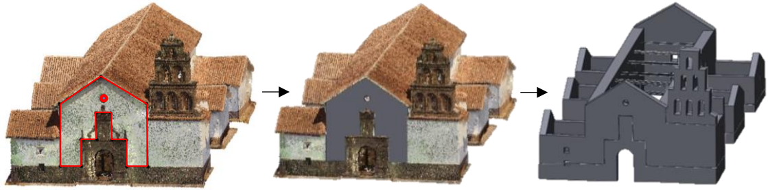
Figura 4.3. Proceso de generación del modelo CAD. De izquierda a derecha: (a) definición de las líneas de contorno, extrusión y modelo final combinado.
