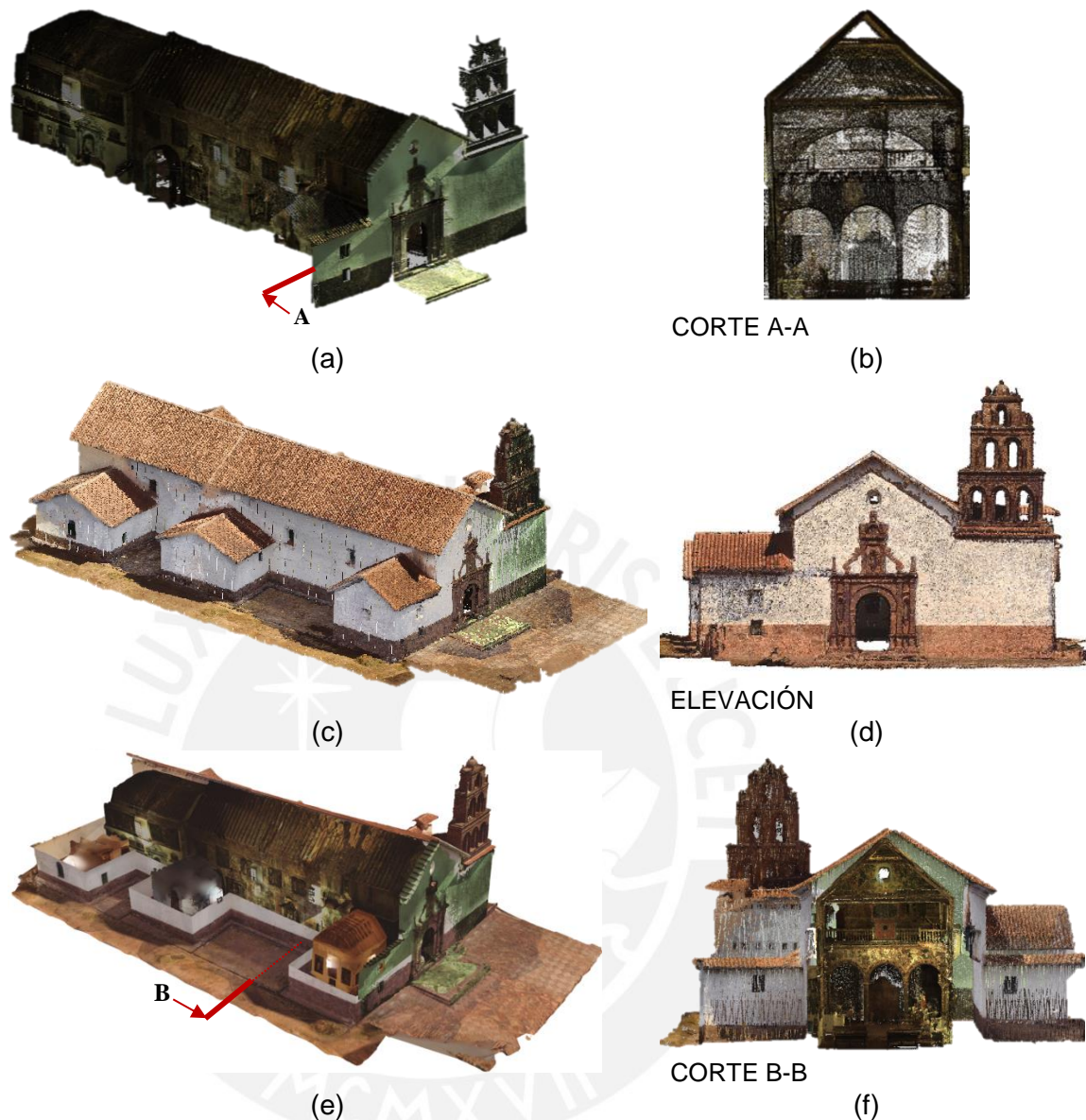
Figura 4.2. Generación de la nube de puntos híbrida usando fotogrametría y TLS: adquisición del modelo interior con TLS (a) vista isométrica, (b) corte A-A; construcción del modelo exterior con fotogrametría (c) vista isométrica, (d) elevación; y generación del modelo híbrido (e) vista isométrica, (f) corte B-B.
