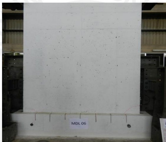
Figura 4.2.19: Muro en estado de daño límite 1 [18].
