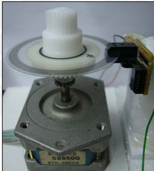
Figura 4.4 Imagen donde se ve el acoplo del encoder al motor de pasos, para la realización de los ensayos.
