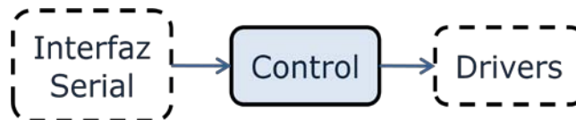
Fig. 3.13 Diagrama de bloque del controlador.
