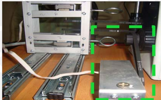
Fig. 3.27 Acoplo del motor que acciona el movimiento en el eje Z.
