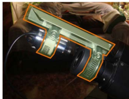
Fig. 3.28 Sujeción de la cámara web Halion M304.
