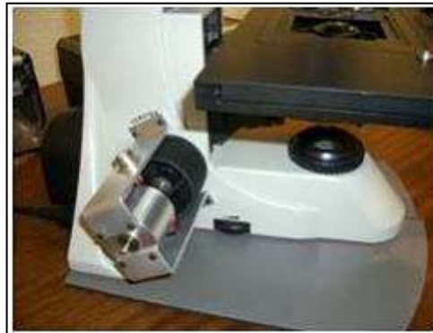
Fig. 2.2 Acoplo del motor en el microscopio utilizado por el trabajo realizado en la universidad de México, para la manipulación del movimiento en el eje Z.
