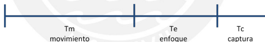
Figura 4.9 Diagrama de tiempos para el análisis automático de muestras.
