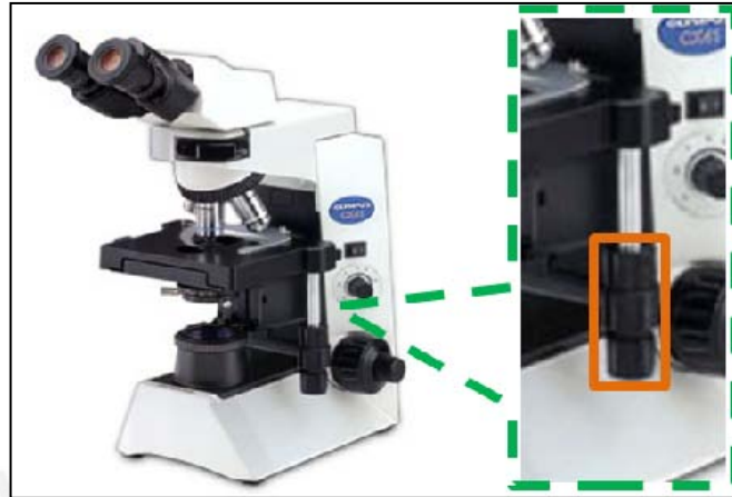
Fig. 3.4 Perillas X e Y ubicadas en la palanca de control que pende de la platina.
