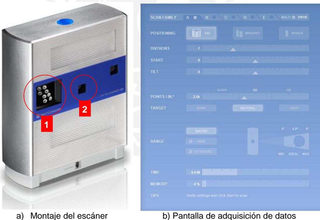
Figura 3.2: a) Se muestra el montaje del NextEngine Laser Scanner HD, se puede identificar la cámara CMOS (2) y los arreglos de láser (1); b) Se muestra la interfaz de usuario del paquete ScanStudioHD que controla la adquisición del escáner, se puede visualizar los modos de operación.
