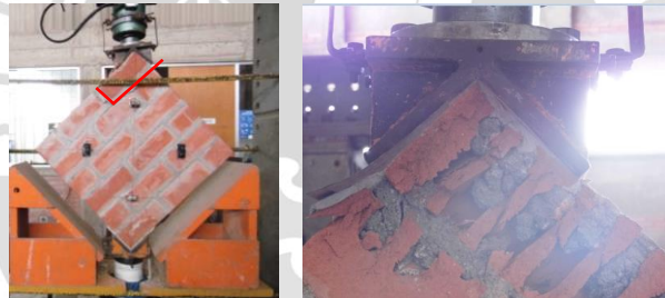
Figura 3.19 – Concentración de esfuerzos en muretes MT01 y MT03
