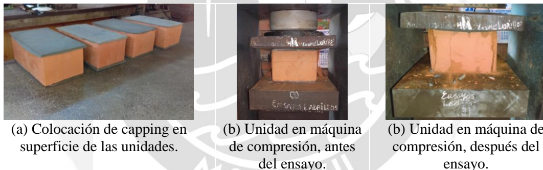
Figura 3.4 - Ensayo de resistencia a la compresión
