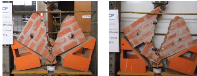
Figura 3.18 – MT02 (izquierda) y MT04 (derecha), falla típica de los muretes del ladrillo de arcilla
