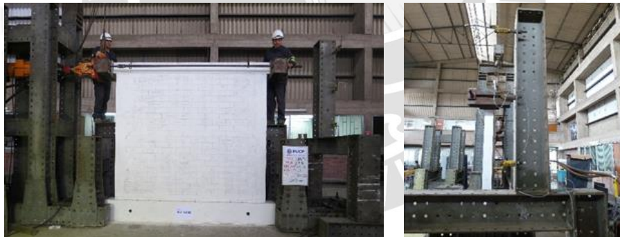
Figura 4.18 - Colocación del actuador lateral y transductores de medición.
