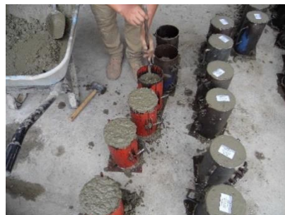
Figura 4.8 - Probetas cilíndricas para control de resistencia.
