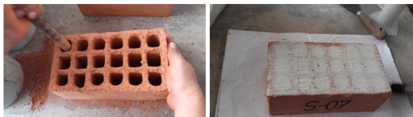
Figura 3.7 - Ensayo de absorción
