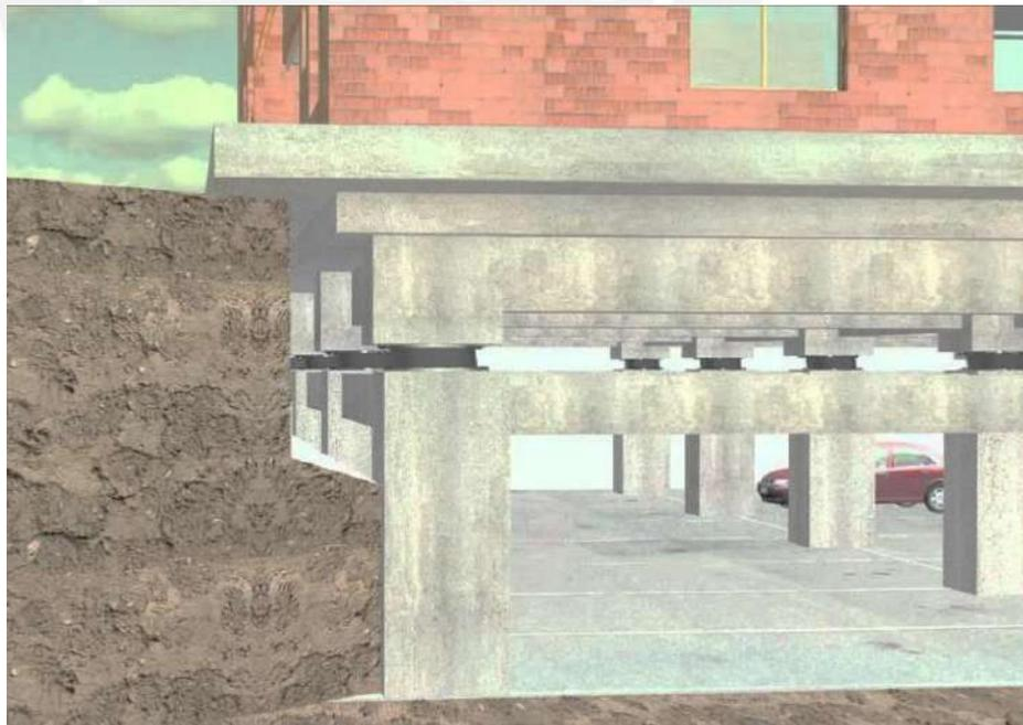
Figura 3.7: Esquema de la Superestructura, Sistema Aislado y Subestructura
