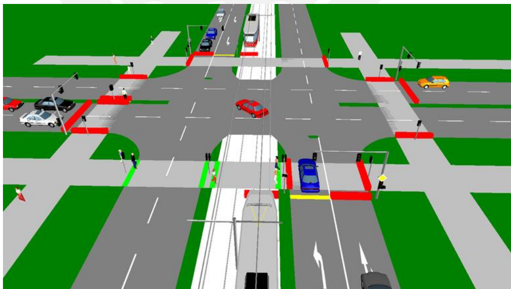
Figura 2.12 Modelo 3D de una intersección semaforizada (Tichý, 2009)
