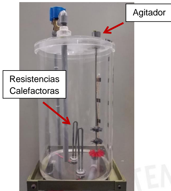
Figura 4.17. Ubicación del agitador y las resistencias
