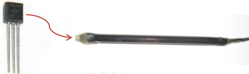
Figura 3.6. Sensor de temperatura LM35 y su cubierta implementada
