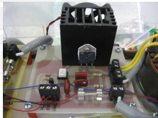
Figura 5.10. Tarjeta de potencia para la segunda resistencia calefactora
