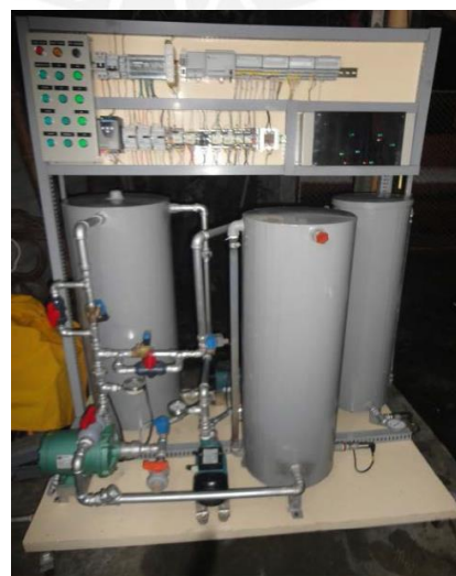
Figura 2.6. Módulo didáctico para control y monitoreo de 3 variables
