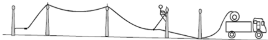
FIGURA 2-10: MÉTODOS DE INSTALACIÓN MANUAL
